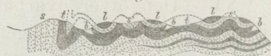
Fig. 1 plan, fig. 2 profil (efter linien AB) af lagren vid Kjellsvikens skifferbrott. b skifferbrott, s undre sandstenen, s' öfre sandstenen, t takskifferlagret, l öfre lerskifferlagret, j jordtäckning.
