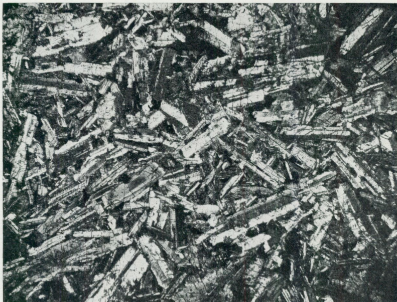
Fig. 94 Mikrofoto av diabas från Brånaberget. Två nikoller, 8 x. Microphoto of dolerite. Crossed nicols, x 8.
