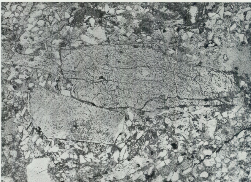
Fig. 37. Matrix i det undre konglomeratets basala del. Större omvandlade plagioklasfragment ligger i en finkornig sericitiserad massa med talrika små fragment av kvarts, kalifältspat och plagioklas. Norr om Vällingträsk. En nikoll, 47x.
