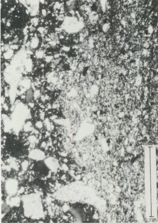
Abb. 6. Dünnschliff des Kontakts von Arkose-Breccie und der Spaltenfüllung aus Loftarsten. Man sieht eine Einregelung länglicher Körner des Loftarsten parallel zur Spaltenwand. Komponenten der Arkose-Breccie ragen aus der Spaltenwand heraus. Komponenten der Arkose-Breccie zeigen keine korrespondierenden Korngrenzen. (Dünnschliff 10/83, gekreuzte Nicols, Maßstab entspricht 1 mm.)
