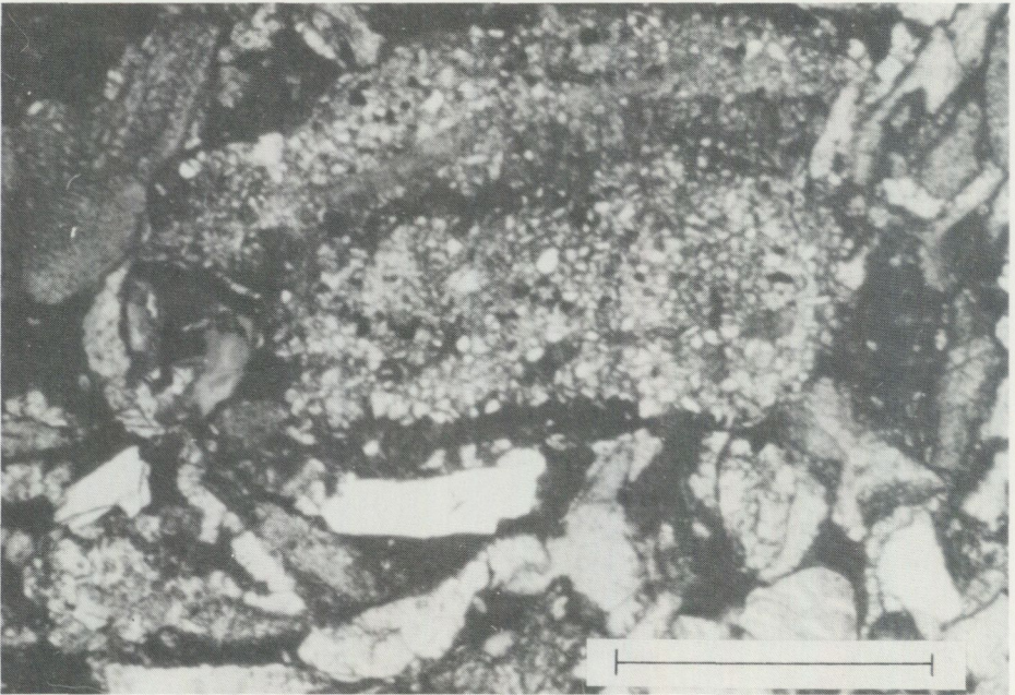
Abb 59. Dem Loftarsten selbst sehr ähnlich sehende Kalksandstein-Komponente im Loftarsten. (Dünnschliff 134/83/e, gekreuzte Nicols, Maßstab entspricht 1 mm.)
