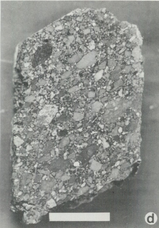
Abb. 68 d. Grobkörniger Loftarsten; deutlich erkennbar eine Einregelung der Körner (im Bild von oben rechts nach unten links orientiert; Schnitt senkrecht zur Schichtung; A 182).
