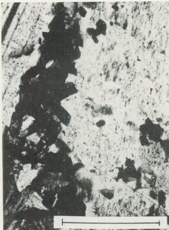
Abb. 12. Verdrängung von Feldspat durch stengelige z.T. idiomorphe Kristalle. (Dünnschliff 55/83, gekreuzte Nicols, Maßstab entspricht 0,5 mm.)
