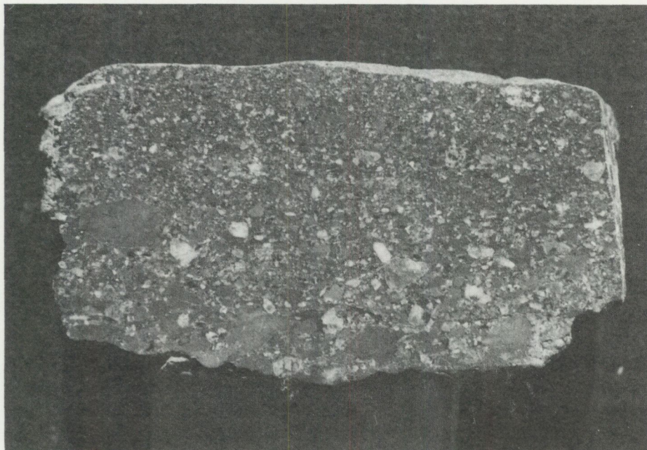
Abb. 35. Übergang von Lockne-Breccie in Loftarsten (A 614/79 am Südufer von Skutetjärnen; Länge des polierten Handstücks etwa 11 cm).
