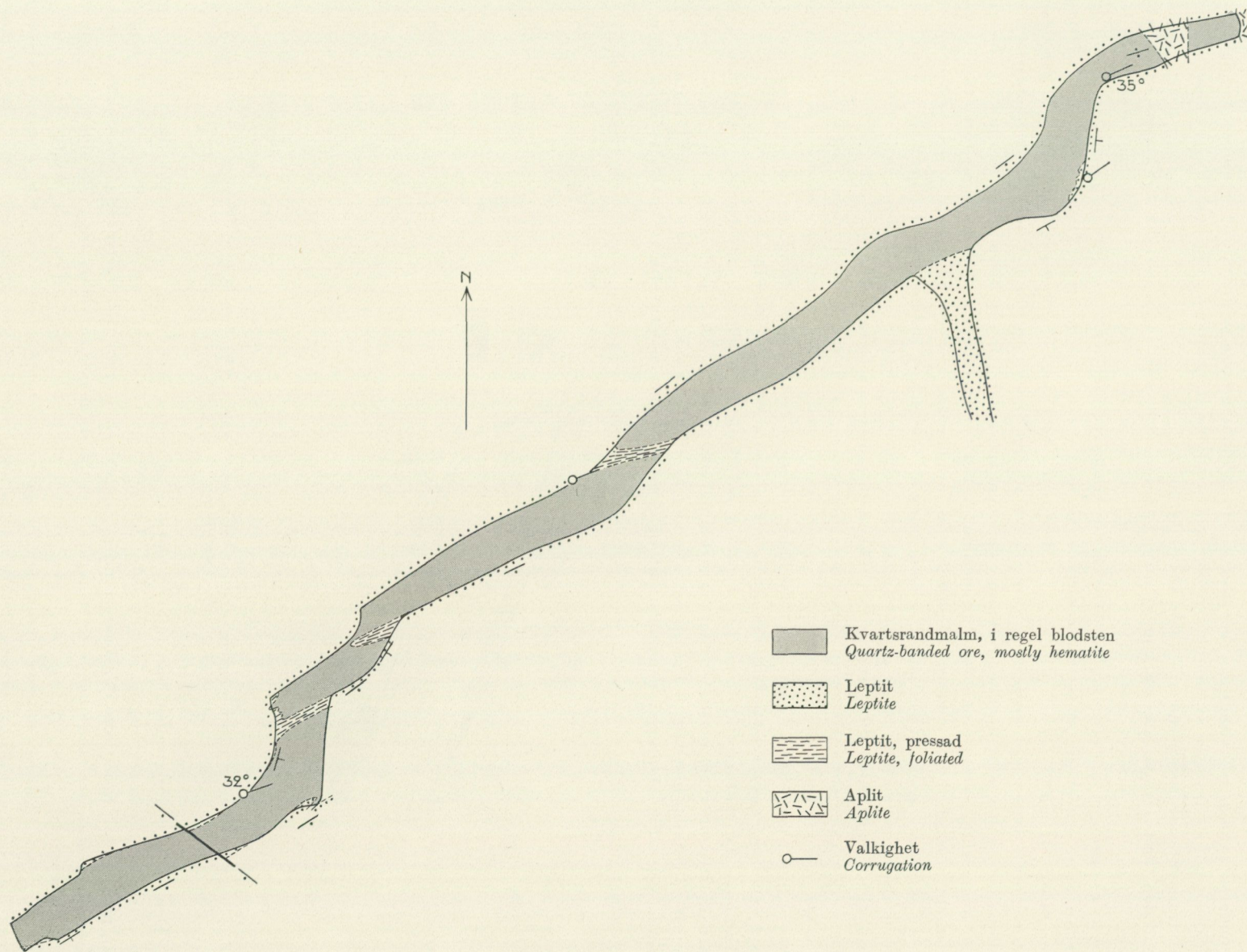
Fig. 15. Parallellmalmen, Stripa, å 220 m avv., visande »omstjärtning», skala 1: 800. The ore body Parallellmalmen, Stripa, on the 220 meter's level, showing echelon displacement. Scale 1: 800.
