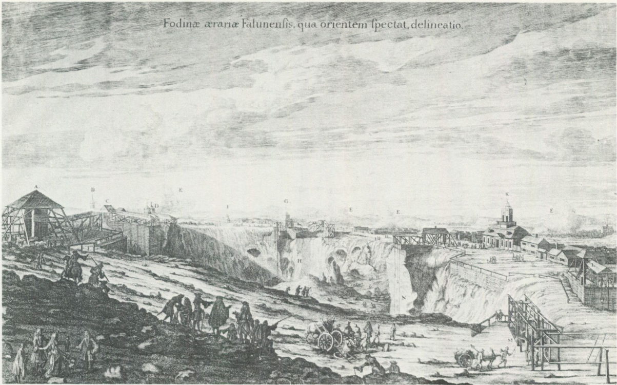
A. Trochlea ad cavernam, Regimini nomine insignitam, Suedice Xegerings Schafst wind. B. Aquæ ductus, ubi collecta in cisternis aqua egeritur, Suedice Rust Stugu. C. Trochlea, quæ iumentis circumagitur, ad cavernam à Rege CAROLO XII dictam, altitudine LX hexapedum seu ulnarum. D. Peritrochium, seu machina tractoria ad cavernam nomine Regine Udalricæ Eleonoræ appellatam, et LX ulnas profundam. E. Furnus ex officinis molliendo metallo constructus, Suedice Kallvofst. F. Vetus Curia metallicorum. G. Peritrochium ad cavernam, quæ columna candida dicitur, vulgo Skankfloten. XL ulnarum profunditate. H. Caverna columnæ candidæ 35 ulnarum. I. Trochlea arcularum, Suedice Kisteninden, 51 uln. K. Curia nova conventus metallicorum constituta. L. Trochlea ad cavernam lignariam, 70 ulnarum. M. Caverna à CAROLO XI dicta, per subterraneos meatus 127 ulnas depressa. N. Lignamentum magnum e columna candida delapsum Anno 1687.
