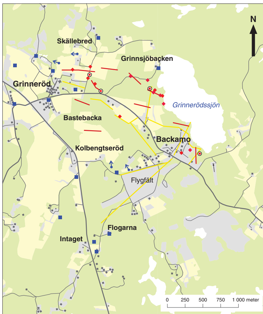
Fig. 12. Markanvändningskarta samt lägen för utförda fältundersökningar enligt tabell 4. gul yta – öppen mark, grön yta – skogsmark, blå linje – mätlinje georadar, röd linje – mätlinje refraktionsseismik, röd diamant – sondering, röd och vit ring – observationsrör, blå pil – källflöden, blå fyrkant – brunn. Beteckningar för respektive linje och punkt framgår av detaljkartorna, figurerna 15 och 19, nedan med undantag för mätlinjer georadar. Dokumentation finns även i kapitlet ”Dokumentation av fältarbeten”.
