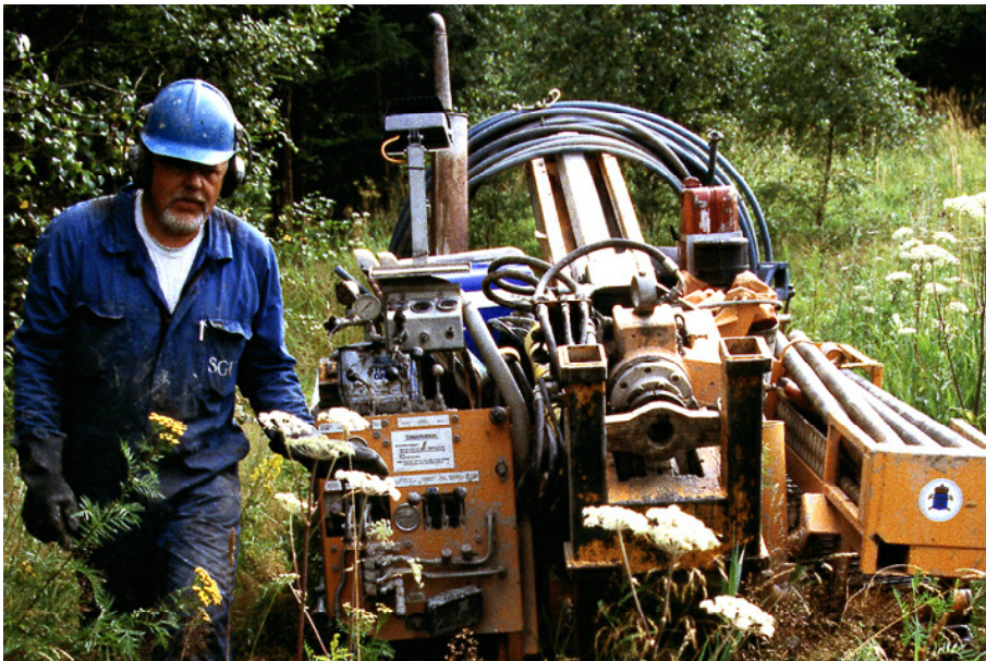
Figur 31. Borrband-vagnen på väg i den norra täkten i Ellesbo. Foto: A. Damberg.
