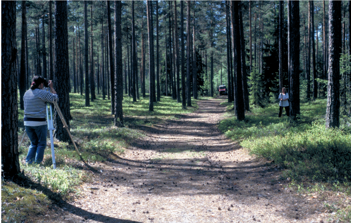
Fig. 4. Geofysiska profiler avvägs för att exakta mått på marktytor, jordartsgränser, grundvattenytor och bergtytor ska erhållas. Foto: C.-F. Müllern.
