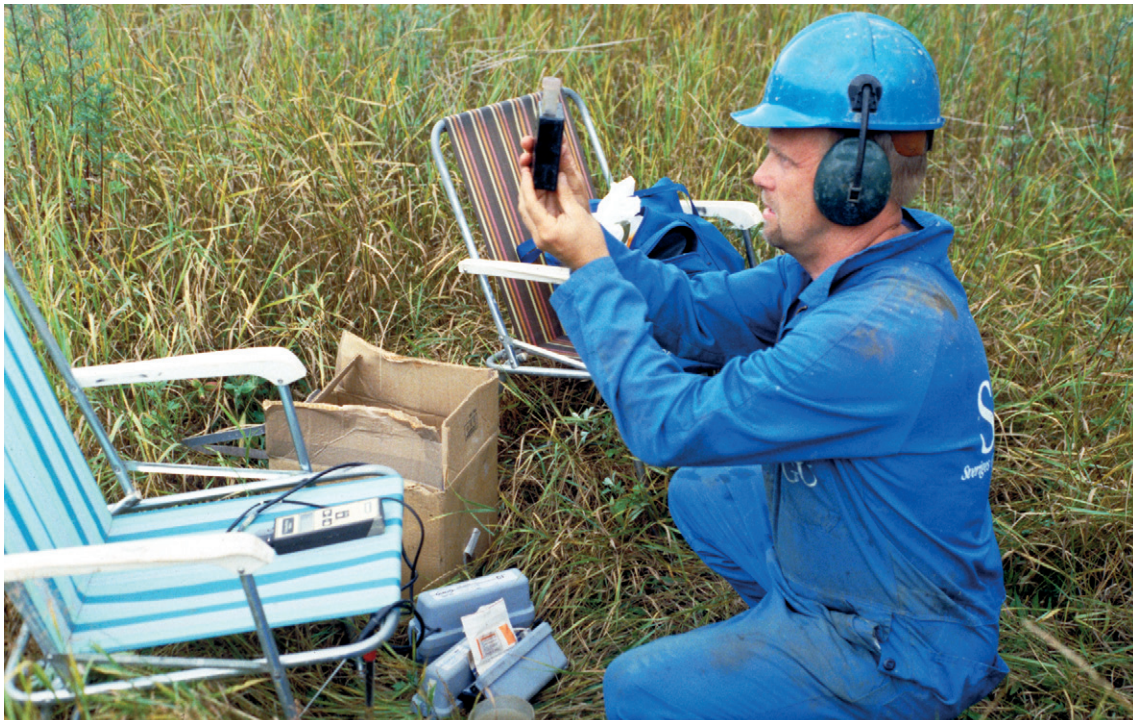
Fig. 6. Preliminära, kemiska analyser på salthalt och järnhalt och mätning av elektrisk ledningsförmåga görs i fält redan under pågående borrhning. Foto: C.-F. Müllern.
