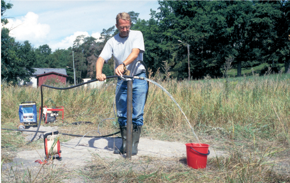
Fig. 8. Efter omsättning av drygt 1 000 liter vatten tas ett prov från observationsröret för fullständig kemisk analys . Foto: C.-F. Müllern.
