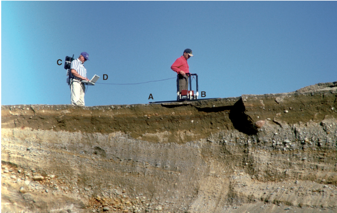
Fig. 2. Georadarmätningar ger information om lagerstrukturer och grundvattenytor. A och B är antenner för sändning och mottagning, C är styrenhet för datainsamling och D är dator med bildskärm. Foto: C.-F. Müllern.
