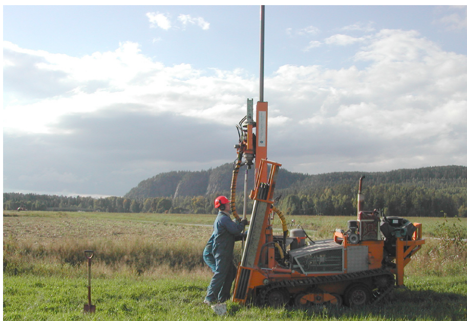
Fig. 13. Borring med SGUs borrhandsvagn i glacial grovsilt och finsand vid Pungmakarbo (8 a). I bakgrunden syns Bispbergs klack. Koordinater 6691583, 1501344. Foto: K. Grånäs.
