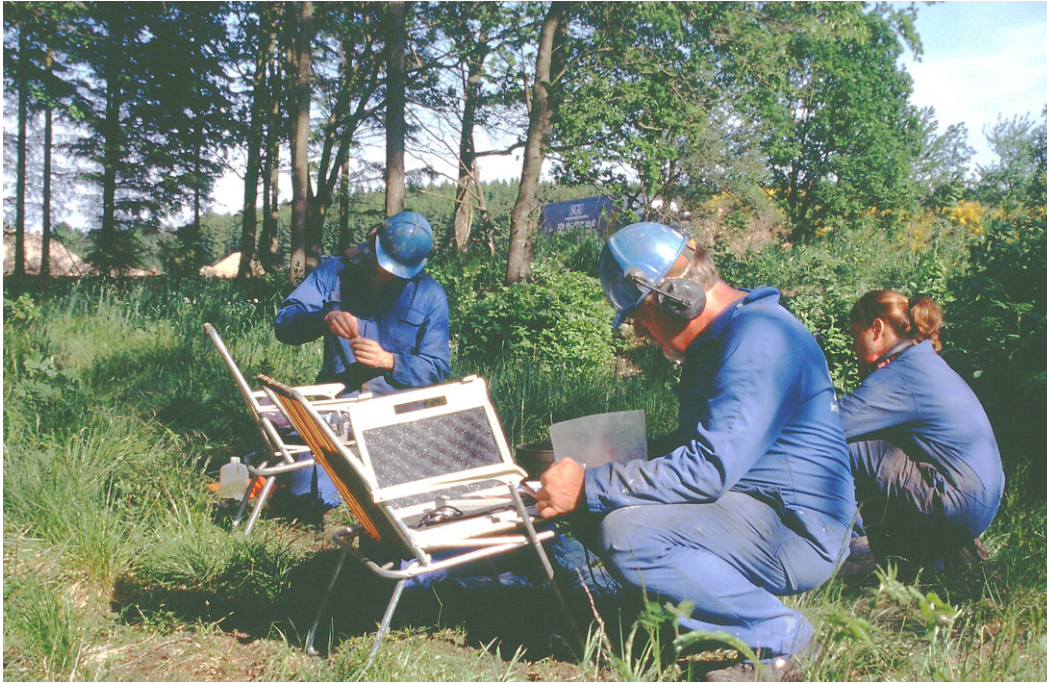
Fig. 12. Vattenprov från R 0201, 16–17 m djup, analyseras: konduktivitet 0,187 mS/cm, temperatur 9,1 °C, Fe 1,8 mg/l och Cl 13 mg/l. Foto: C.-F. Müllern.
