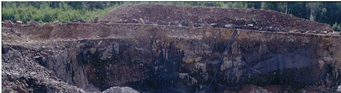
Figur 54. Detalj av foto från bergtäkten 1700 m öster om Tåstarps kyrka. Jordlagret (ljusare i bilden) är endast några få meter mäktigt.
