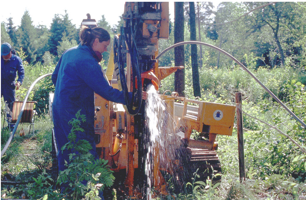
Fig. 11. Provtagning för kemisk analys i fält av vatten från R 0201. Foto: C.-F. Müllern.
