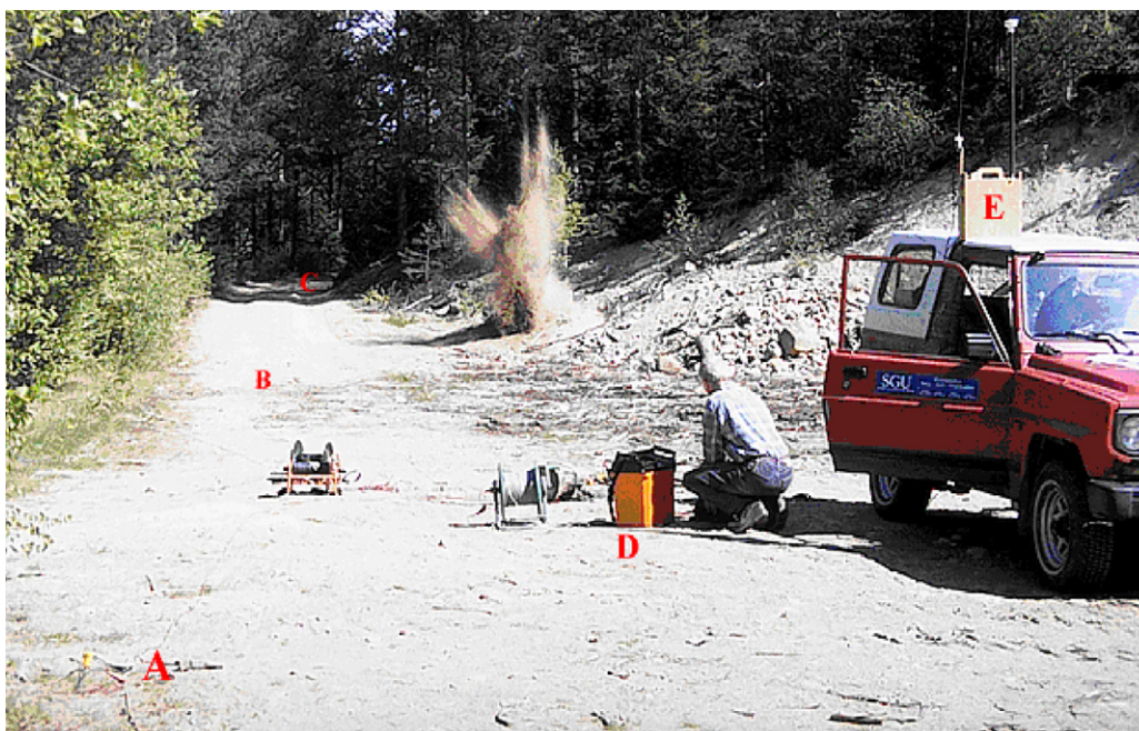
Fig. 7. Vid seismiska mätningar detoneras en mindre dynamitladdning och ljudvågorna som fortplantar sig i marken registreras av geofoner vid A, B och C. D är en seismograf som ritar upp och lagrar kurvor för ljudvågornas utbredning. E är GPS-mottagare för positionering. Foto: C.-F. Müllern.
