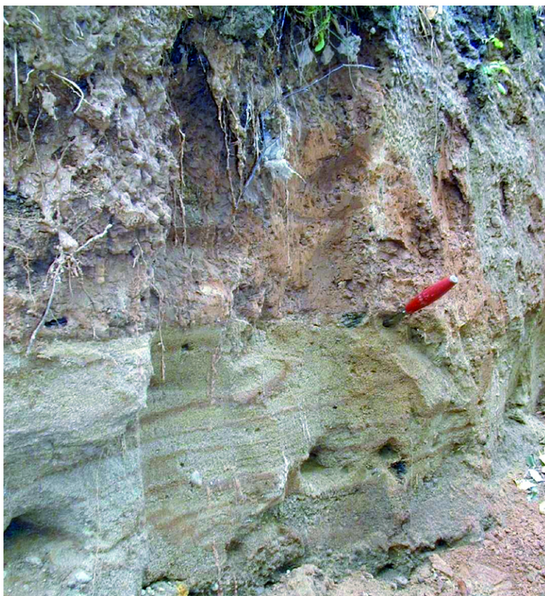
Fig. 3. Omkring 1 m lerig siltig, rödbrun, block- och stenfattig morän överlagrar sorterade, äldre isälvsediment i södra delen av Tenhult (9 c). Foto: Lars-Erik Olander.
