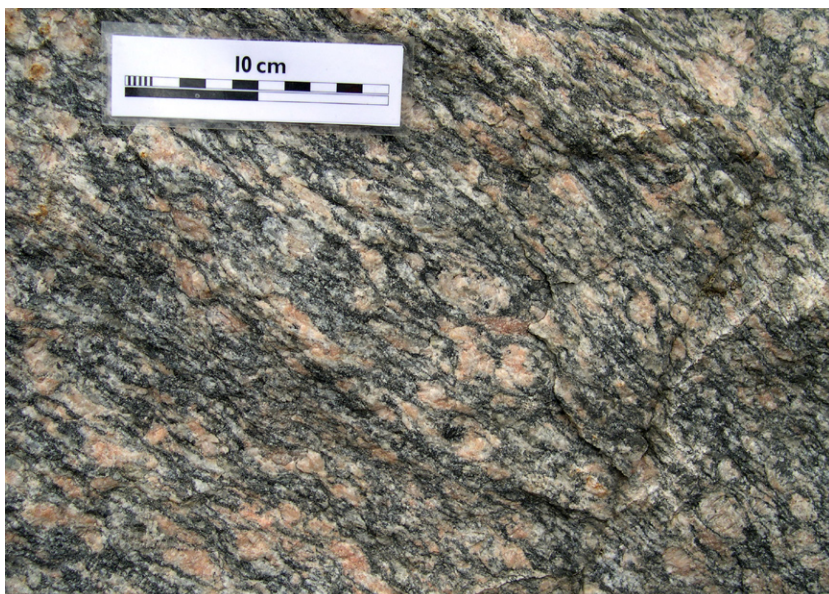
Fig. 5. Rödgrå, porfyrisk metagranit från en väghäll norr om Ängsvik. Bergkvalitetsklass 1,5 (väg). CMT040087 (6588523/1653579). Foto: Malin Sträng.
