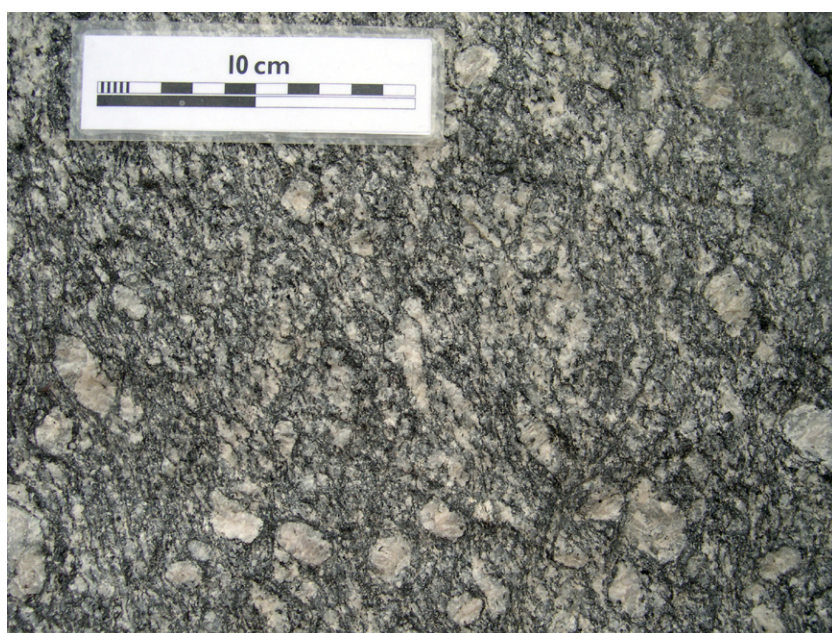
Fig. 2. Grå, porfyrisk metagranodiorit från en väghäll öster om Brunn. Bergkvalitetsklass 1 (väg). MPA040041 (6576370/1650835). Foto: Malin Sträng.
