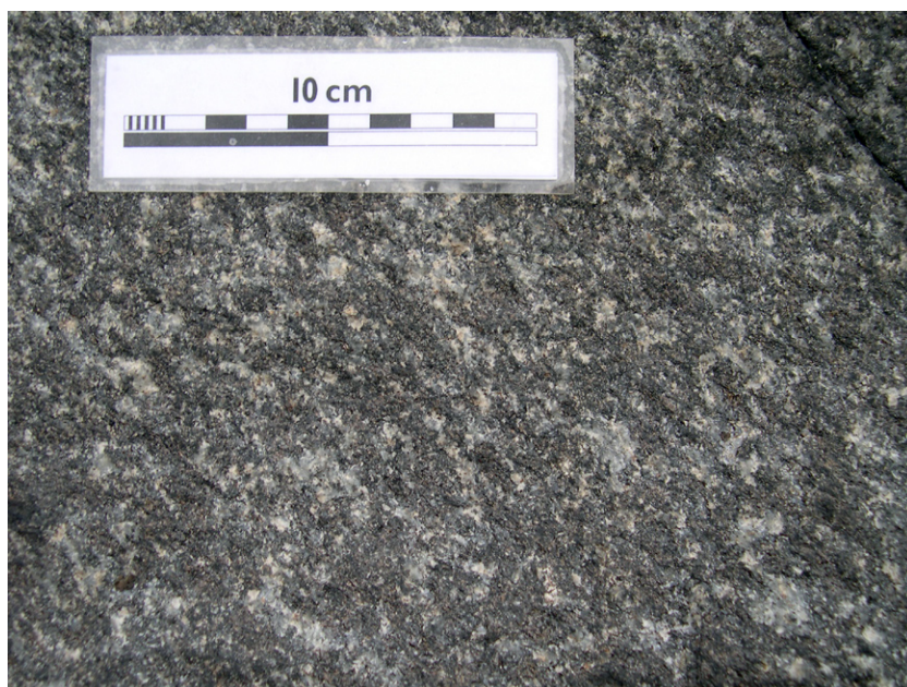
Fig. 3. Mörkgrå, folierad metatonalit från en väghäll söder om Hasselmara. Bergkvalitetsklass 2 (väg). FHA040200 (6575386/1659175). Foto: Malin Sträng.
