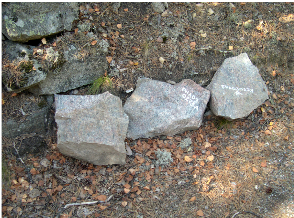
Fig. 1. Vid provtagning av bergmaterial för teknisk analys tas normalt ca 2 till 4 bergblock ut för att representera hållen, uppskattningsvis ca 50 kg. Blocken på bilden är ca 30 till 40 cm i diameter. Foto: Fanny Hartvig.
