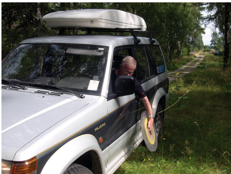
Figur 13. Utlägg av den seismiska profilen S15-04 vid Tånga hed.
