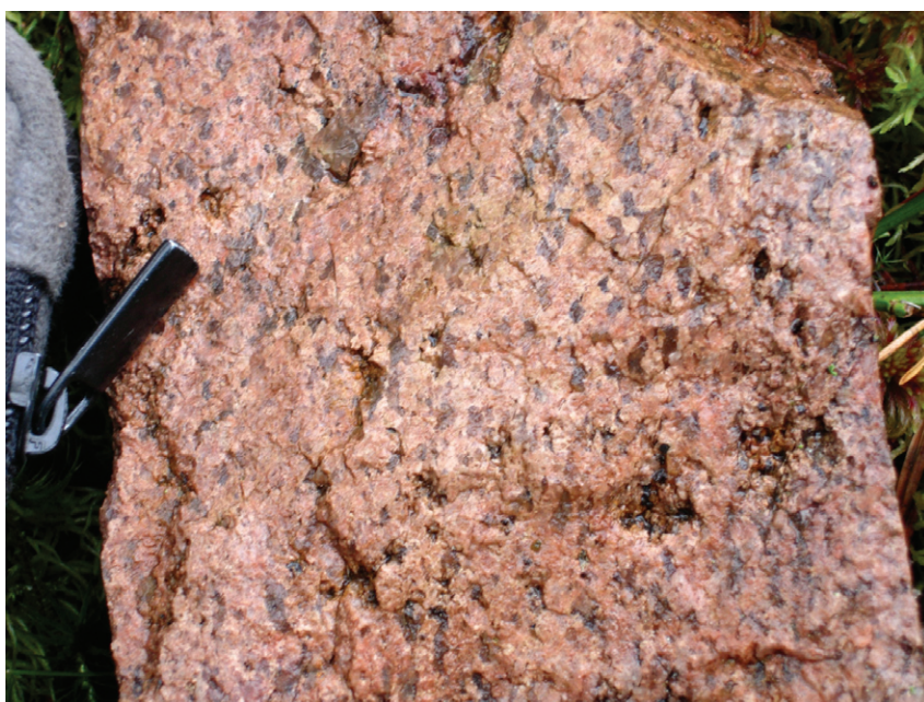
Figur 7. Röd, fint medelkornig, jämnkornig, omkristalliserad, leukokratisk granit (MGO060005A) med dåliga tekniska egenskaper, A_N = 19,7\% och LA = 36,8\% . Vyn är 15 \times 10 cm. Foto: Mattias Göransson.
