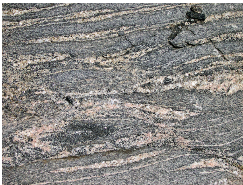
Figur 5. Grå, medelkornig, ådrad, tonalitisk gnejs (MGO035083A) med dåliga tekniska egenskaper, A_N = 21,2\% och LA = 41,2\% . Vyn är ca 80 \times 60 cm. Foto: Mattias Göransson.
