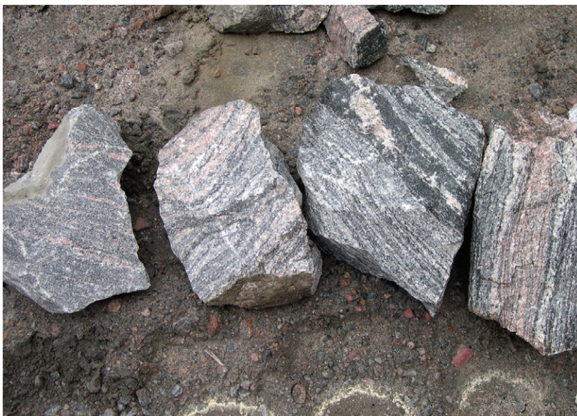
Figur 3. Vid provtagning väljs tre till fyra större block ut (ca 60 kg) som är representativa för berghällen. I detta heterogena prov varierar både kornstorleken, frekvensen av ådror och den mineralogiska sammansättningen. Vyn är ca 120 × 90 cm. Foto: Mattias Göransson.
