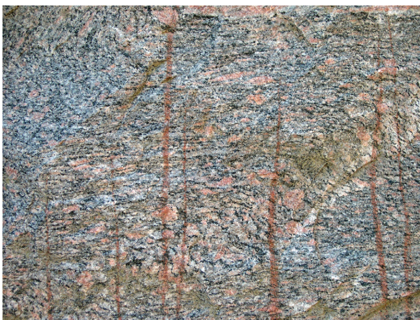
Figur 6. Rödgrå till gråröd, medelkornig, veckad, grovporfyrisk granitisk gnejs (MGO045056A), med läkta, oxiderade tensionssprickor (röda) och moderata tekniska egenskaper, A_N = 12,8\% och LA = 23,3\% . Vyn är ca 70 \times 100 cm. Foto: Mattias Göransson.
