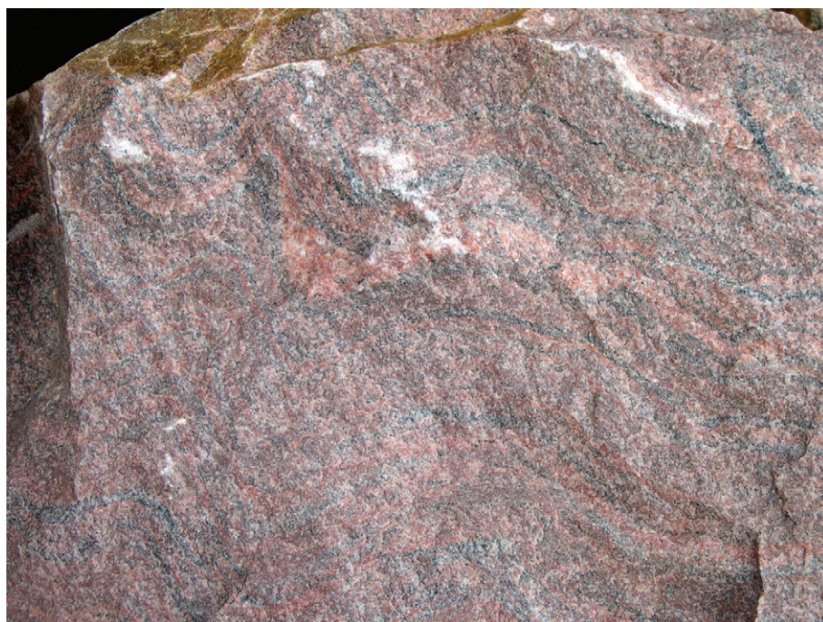
Figur 11. Röd, fint medelkornig, veckad, granitisk gnejs (MGO045062A) med bra tekniska egenskaper, A_N = 9,3 % och LA = 25,3 %. Vyn är ca 65 × 45 cm. Foto: Mattias Göransson.
