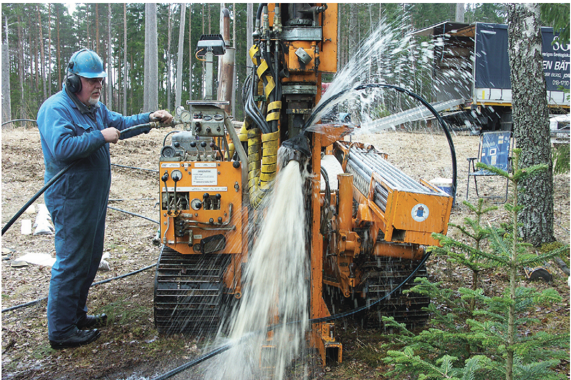
Fig. 40. Från borrhningen av R 0415. Sandiga—grusiga, starkt vattenförande lager med mäktigheter på 20–30 m påträffades i flera borrhningar. Foto: Carl-Fredrik Müllern.
