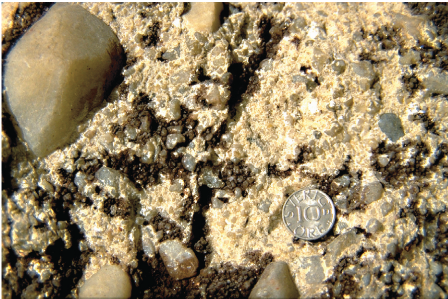
Fig. 17. Det allra understa lagret i den sedimentära bergartsserien utgörs på många ställen av ett grovkornigt och vattengenomsläppligt konglomerat. De mörkbruna järn- och manganutfällningarna återspeglar de för grundvattenströmning öppna kanalerna. Foto: Carl-Fredrik Müllern.
