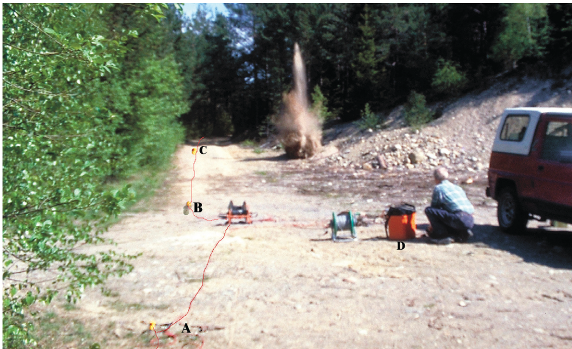
Fig. 80. Vid seismiska mätningar detoneras en mindre dynamitladdning och ljudvågorna som fortplantar sig i marken registreras av geofoner vid A, B och C. D är en seismograf som ritar upp och lagrar kurvor för ljudvågornas utbredning. Foto: Carl-Fredrik Müllern.
