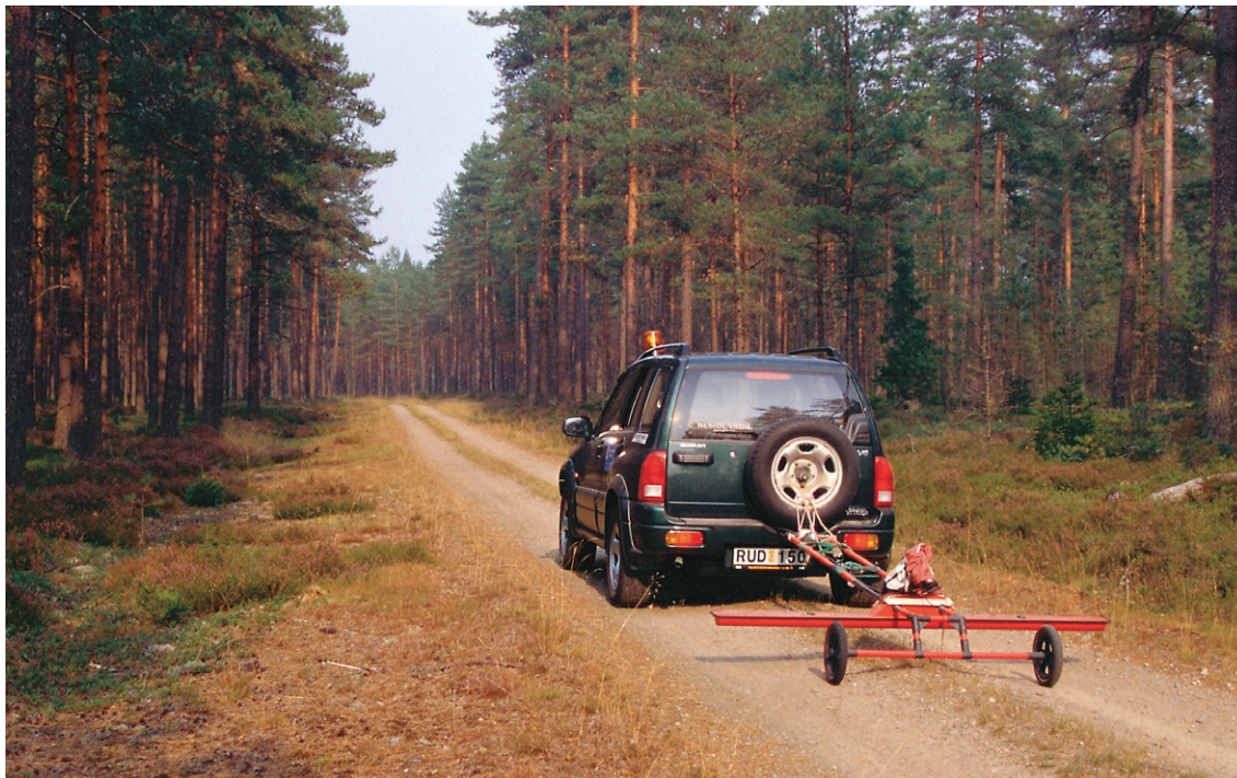
Fig. 78. Georadarmätningar görs mestadels på skogsbilvägar och större stigar. Större vägar är vanligen saltade mot halka och damning. Där blir tillräckligt mycket salt kvar i vägbanan för att störa mätningarna. Foto: Carl-Fredrik Müllern.
