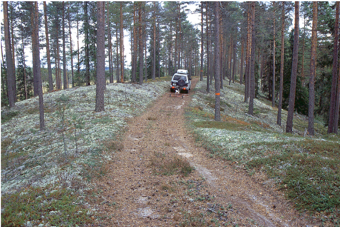
Fig. 3. Georadarmätning längs en dyn, Stortjärnsmanen ca 1 km nordväst om Alsterns nordände. Mätningmomentet sker med bilburen utrustning med en hastighet av ca 10 km per timme. Foto: Carl-Fredrik Müllern.
