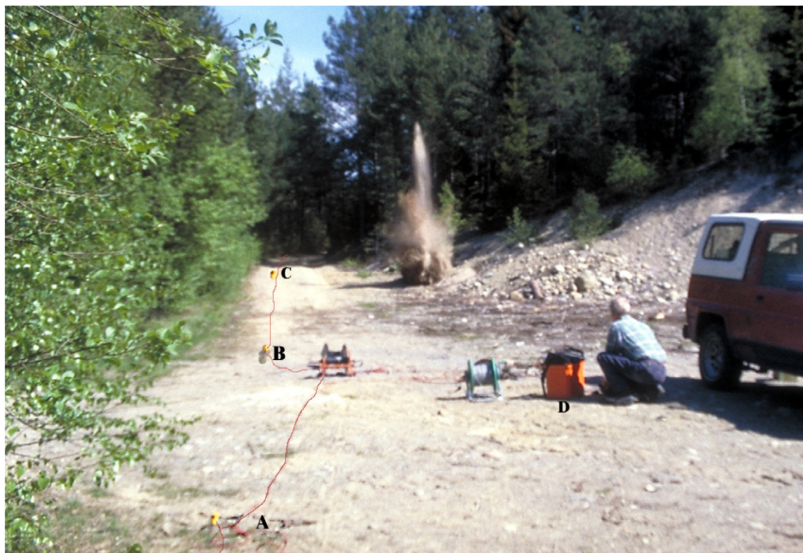
Fig. 64. Vid seismiska mätningar detoneras en mindre dynamitladdning, och ljudvågorna som fortplantar sig i marken registreras av geofoner vid A, B och C. D är en seismograf som ritar upp och lagrar kurvor för ljudvågornas utbredning. Foto: Carl-Fredrik Müllern.
