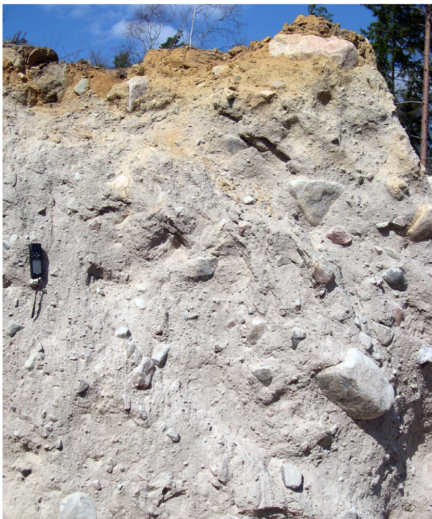
Fig. 21. Sandig morän med måttlig halt sten. Moränen är i detta fall relativt lucker och innehåller en del sandlinser. Omkring 600 m norr om Stråhult (9 b). Foto: E. Daniel.
