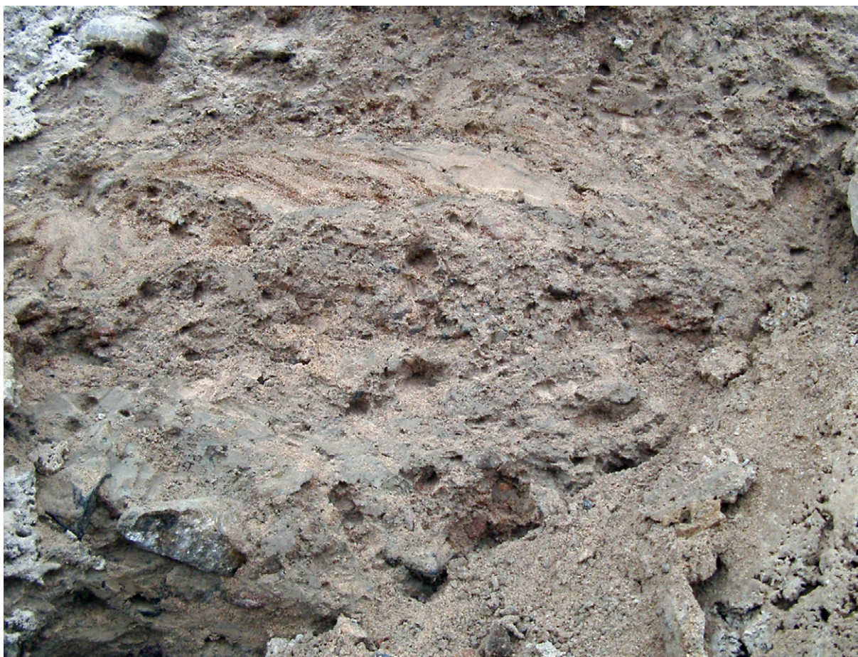
Fig. 13. Skikt av sand och silt i morän, mer eller mindre deformerade, är vanligt förekommande. Från schaktning för nya väg E4 ca 1 km sydost om Skånes Fagerhult (o b). Foto: M. Persson.
