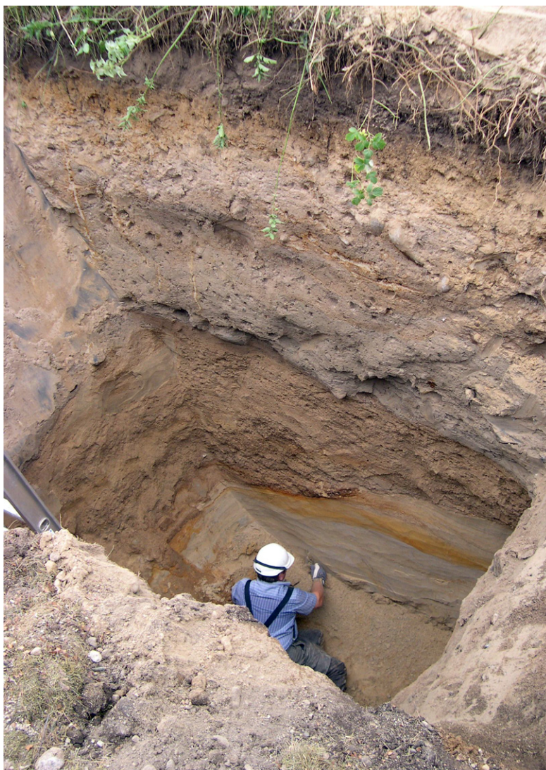
Fig. 17. Undersökningsschakt vid Grims-lövs Folkhögskola, vid Grimslövs by (8 e). I schaktet syns överst sandig morän underlagrat av en något grusig sand samt underst finsand. Professor Per Möller i arbete i schaktet. Foto: Esko Daniel.
