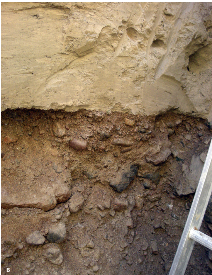
Fig. 12. A. Siltig morän, överst i provgroppen i Kråketorp (8 h). Foto: E. Magnusson. B. Submoräna isälvssediment bestående av silt och finsand som överlagrar stenigt grus, Kråketorp (8 h). Foto: E. Magnusson.
