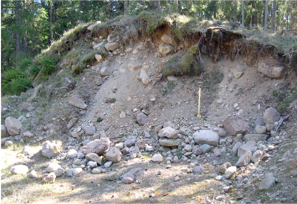
Fig. 5. Skärning genom en liten ås med ofullständigt sorterat, stenigt och blockförande grus. Foto: Esko Daniel.
