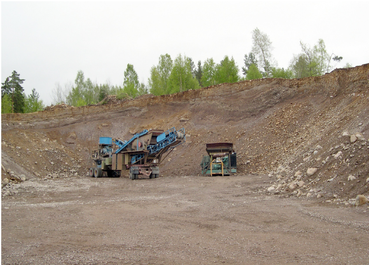
Fig. 7. Foto mot söder av grustag i östra sidan av åsen mellan sjöarna Örlen och Viken 500 m söder om Musko (8 b). Bilden visar en upp till 10 m hög skärning i lager av stenigt grus och sandigt grus. Foto: A.G. Lindén.
