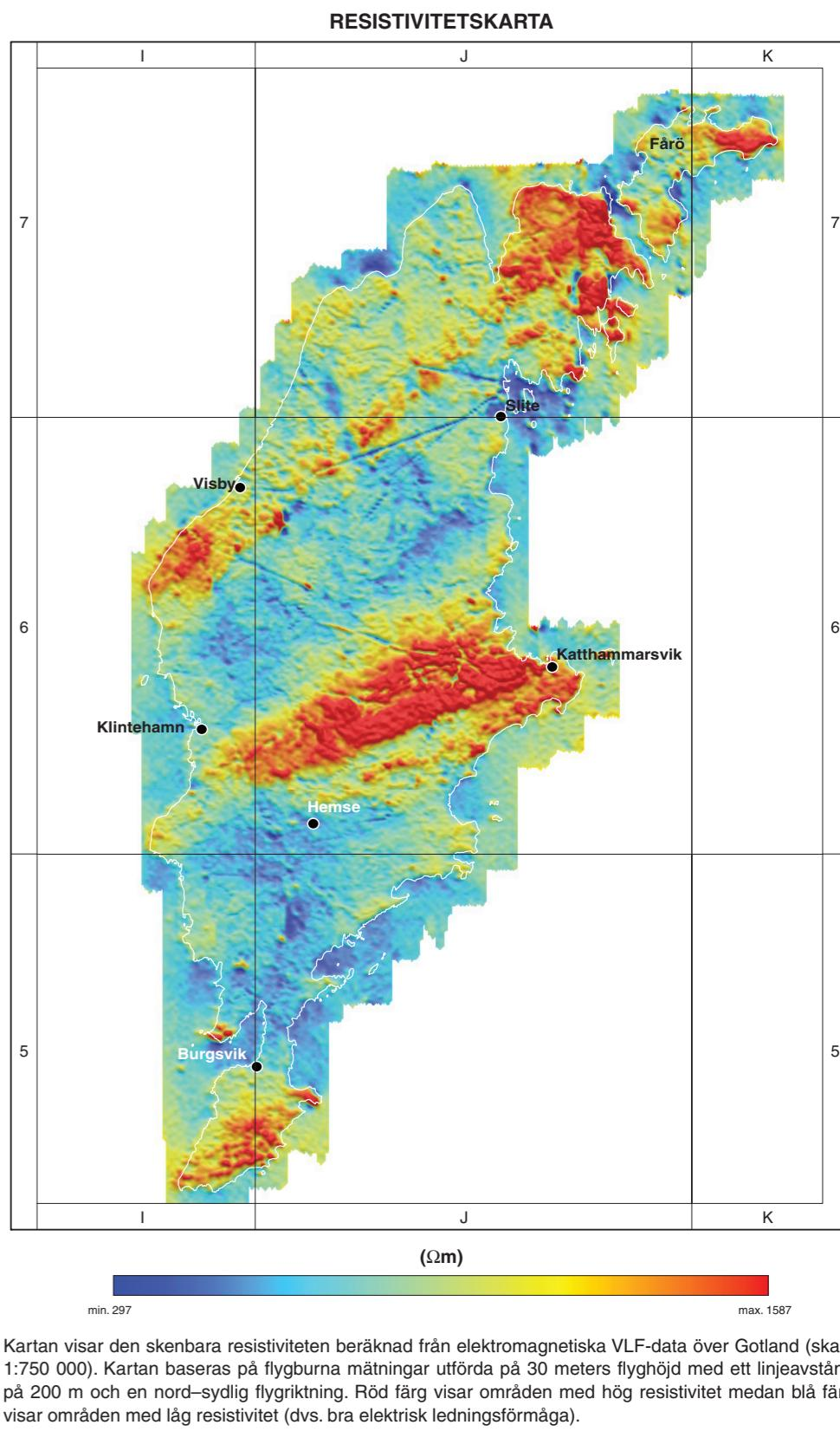
Kartan visar den skenbara resistiviteten beräknad från elektromagnetiska VLF-data över Gotland (skala 1:750 000). Kartan baseras på flygburna mätningar utfrida på 30 meters flyghöjd med ett linjeavstånd på 200 m och en nord-sydlig flygriktning. Röd färg visar områden med hög resistivitet medan blå färg visar områden med låg resistivitet (dvs. bra elektrisk ledningsförmåga).
