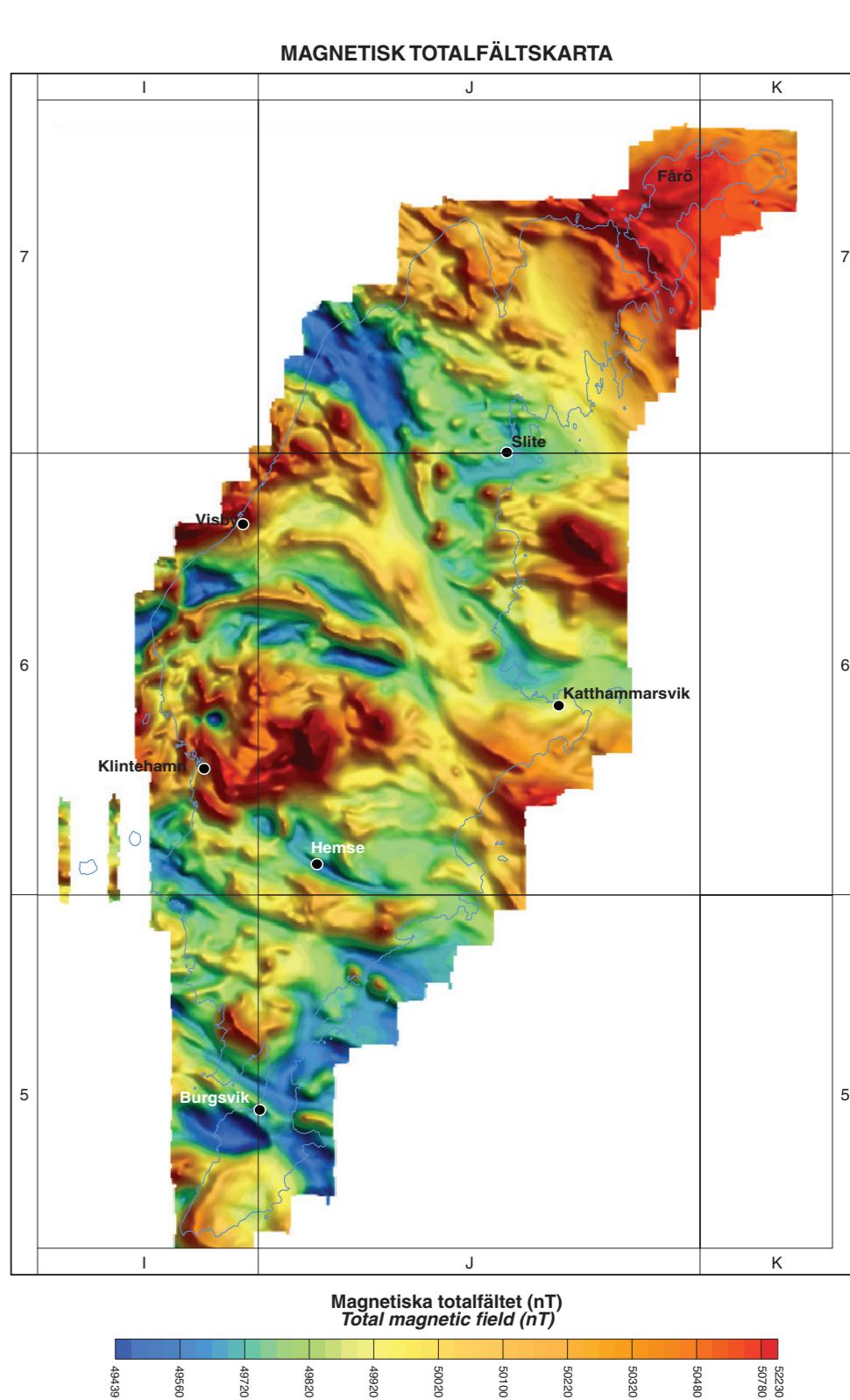
Magnetisk anomalkarta över Gotland (skala 1:750 000). Magnetiska data är reducerade till epok 1965.0. Kartan visar totalfälts avvikelse från DGRF 1965.0. Den baseras på flygburna mätningar utfrida på 30 meters flyghöjd med ett linjeavstånd på 400 m och en nord-sydlig flygriktning.
