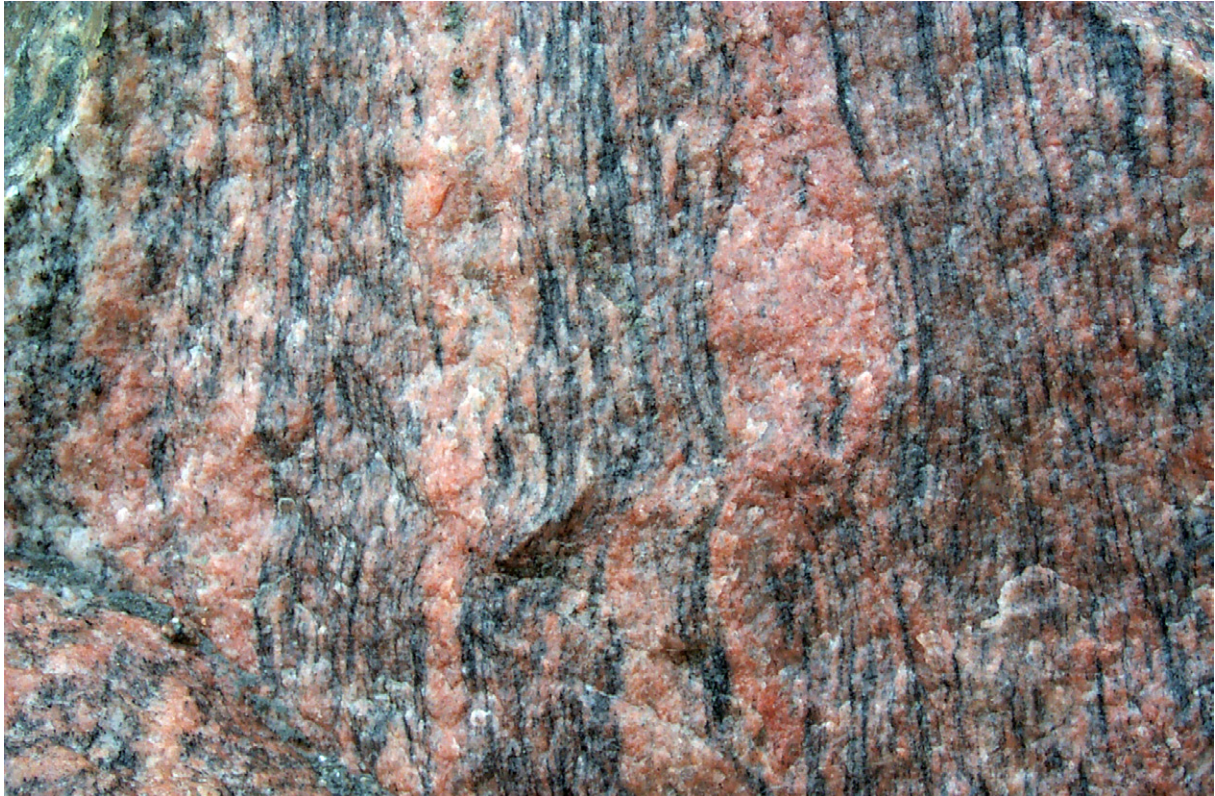
Fig. 6. Gnejsig granit, migmatitiserad. Strömkorn 1–3 cm. LEP010013, Kungsör bergtäkt vid Nytorp, 6584350/1516460. Kungsör quarry. Migmatised, gneissic granite. Megacrysts c. 1–3 cm.
