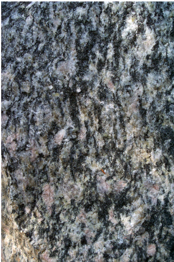
Fig. 4. Gnejsig granit med strökorn (2–3 cm) av fältspat. LEP0100029, norr om Blixbo, 6615600/1509580. Gneissic granite with feldspar megacrysts (2–3 cm).
