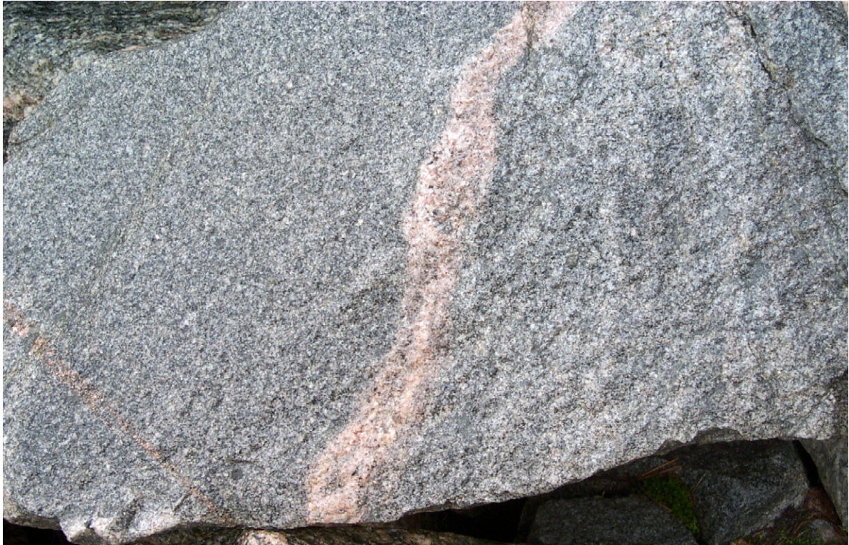
Fig. 11. Grå, fint medelkornig, yngre granit med pegmatitsliror. Vägskäring nära Loviseberg. LEP000140, 6598680/1528500. Grey, finely medium-grained, younger granite with pegmatitic schlieren. Road cut.
