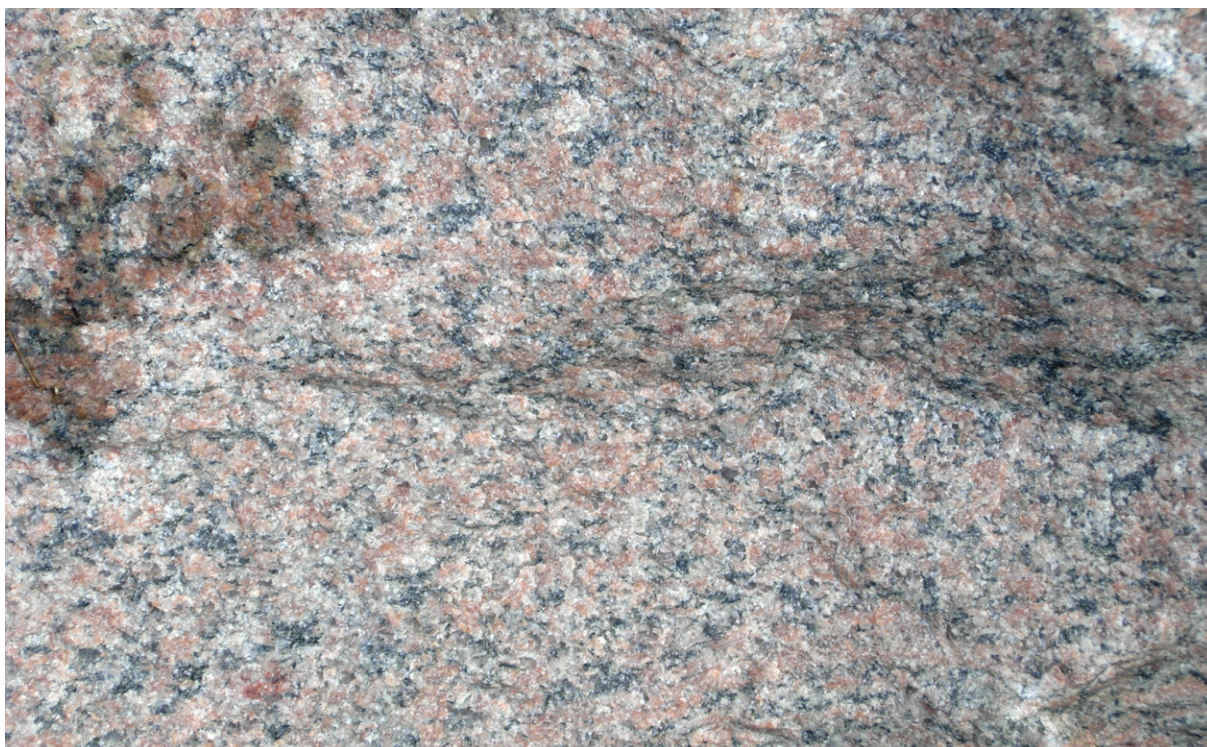
Fig. 8. Grå-röd, gnejsig, grovt medelkornig, porfyrisk granit från en tillfartstunnel till ett bergrum strax norr om Susegårdén (MGO075001A, 6301283/1317254). Provet taget från den här platsen ger mycket dåliga tekniska egenskaper: A_N -värde = 20 % och LA-värde = 54 %. Vyn är ca 14–20 cm. Foto: Mattias Göransson.
