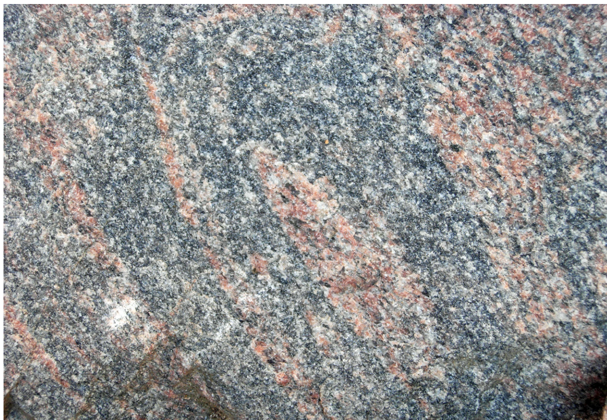
Fig. 5. Rödgrå, medelkornig, migmatitisk, ådrad, granitisk gnejs (MGO080009A, 6301918/1309457) med de tekniska egenskaperna A_N -värde = 13 % och LA-värde = 31 %. Vyn är ca 18–24 cm. Foto: Mattias Göransson.
