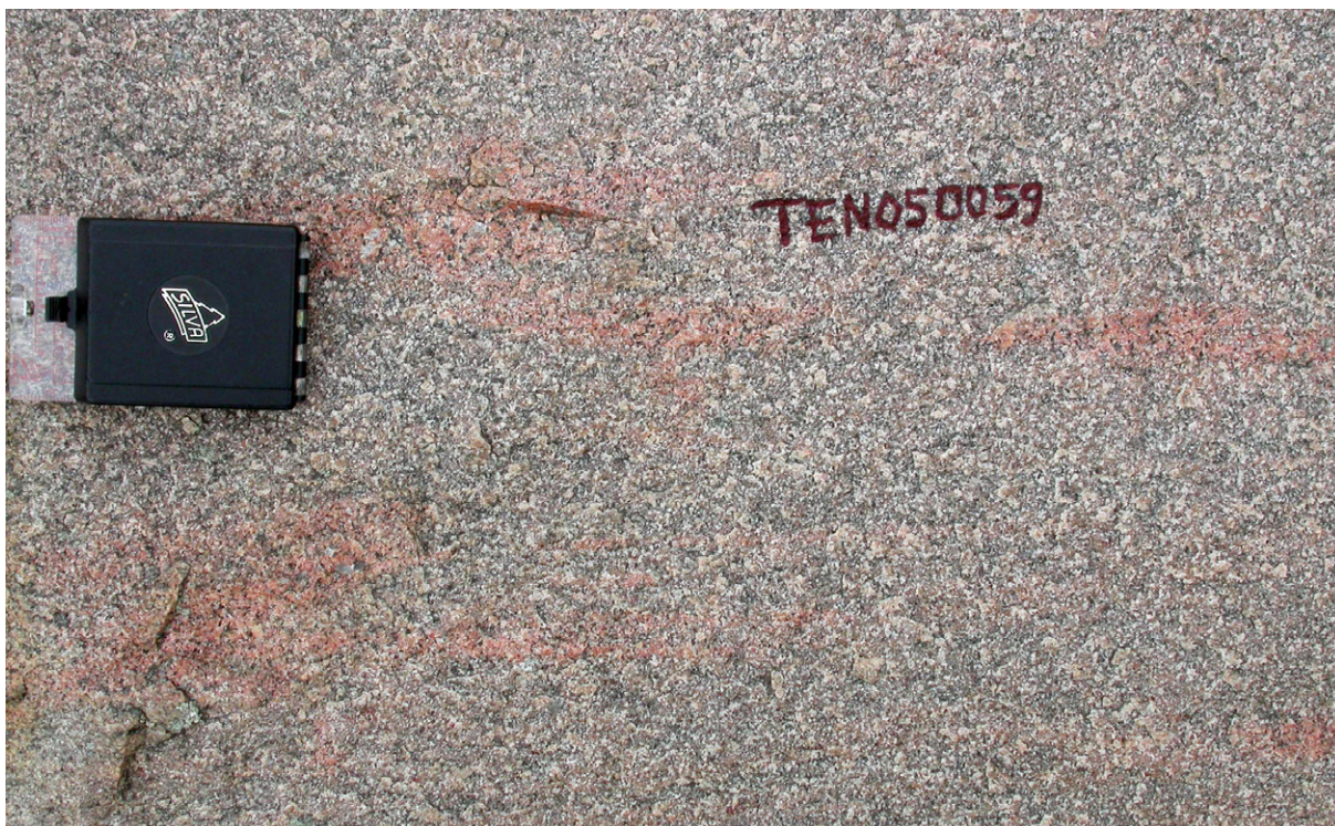
Fig. 9. Rödgrå till grå-röd, svagt gnejsig, leukokratisk granit (TEN050059, 6283557/1314456). Den här bergarteren har ofta bra till medelbra tekniska egenskaper. Foto: Thomas Eliasson.
