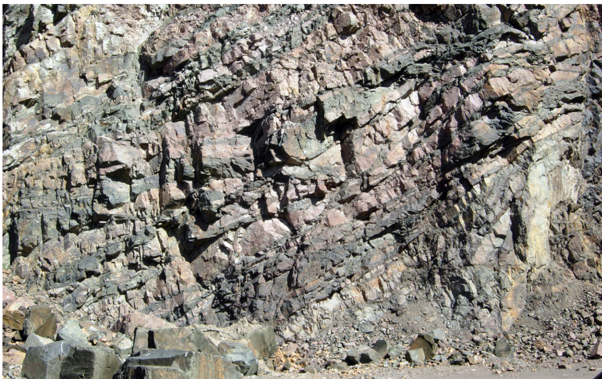
Fig. 4. Röd, finkornig gnejs med svarta amfibolitgångar, Dalby stenbrott (MGOo80011A, 6172512/1348074), med mycket bra tekniska egenskaper: A_N -värde = 5 % och LA-värde = 16 %. Vyn är ca 5 x 8 m. Foto: Mattias Göransson.
