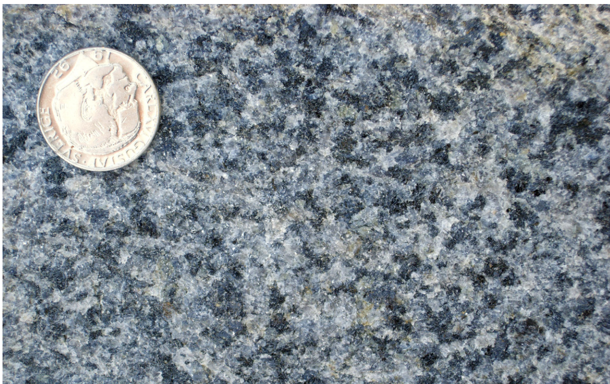
Fig. 6. Grå, medelkornig, massformig monzogranit till granodiorit (MGO080010A, 6158424/1361032) från bergtälkten Bellinga. Berget har medelbra tekniska egenskaper: A_N -värde = 12 % och LA-värde = 26 %. Myntet är 2,5 cm i diameter. Foto: Mattias Göransson.
