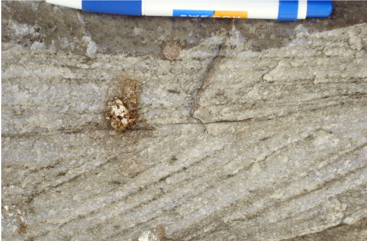
Fig. 8. Kambrisk korsskiktad sandsten (MGO075106A, 6177827/1342189) från Hardebergabrottet med bra tekniska egenskaper: A_N -värde = 8 % och LA-värde = 26 %. Pennan är ca 14 cm lång. Foto: Mattias Göransson.
