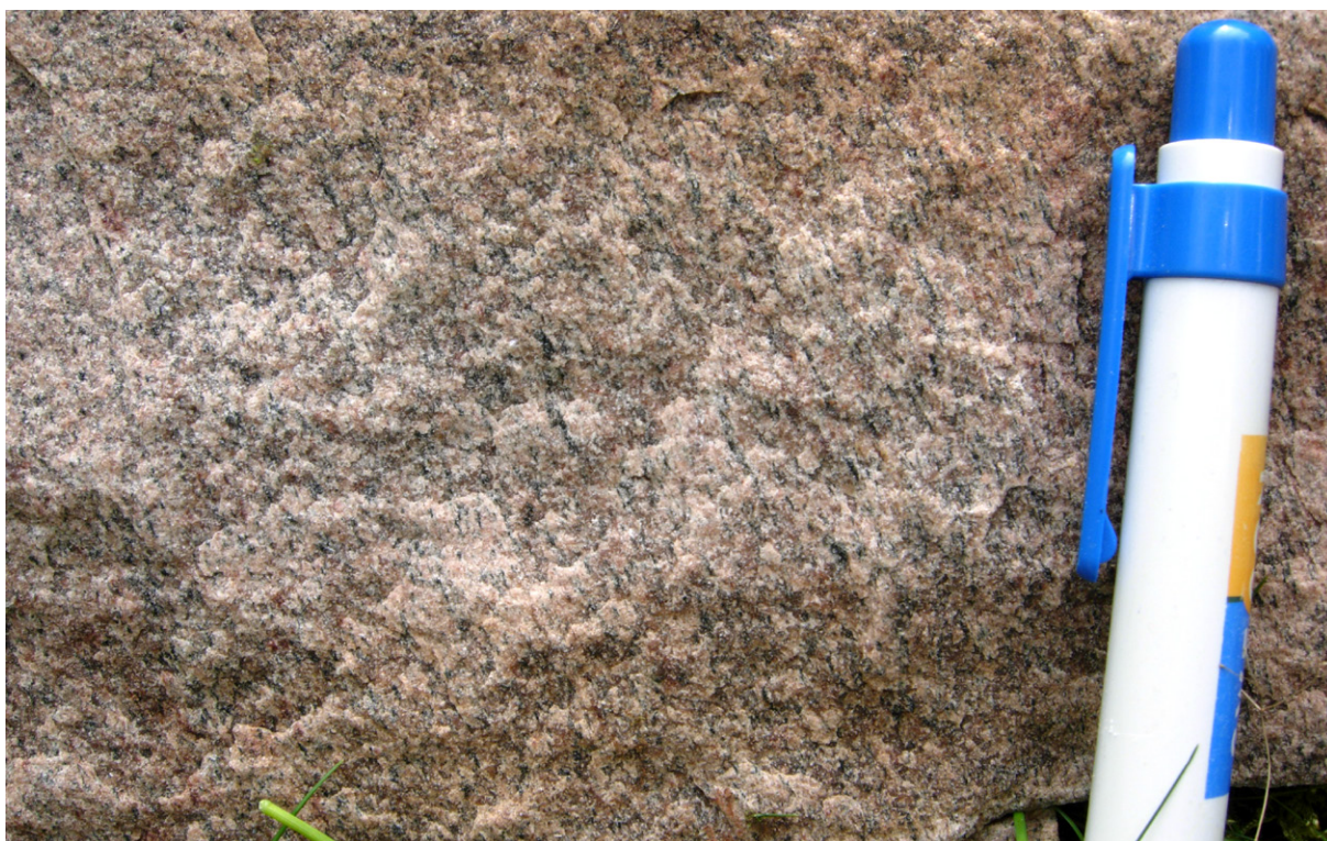
Fig. 5. Röd, finkornig, gnejs, ca 3,3 kilometer ostnordost om Genarps kyrka (MGOo80015A, 1350432/6167080) med bra tekniska egenskaper: A_N -värde = 9 % och LA-värde = 26 %. Vyn är ca 10 x 13 cm. Foto: Mattias Göransson.
