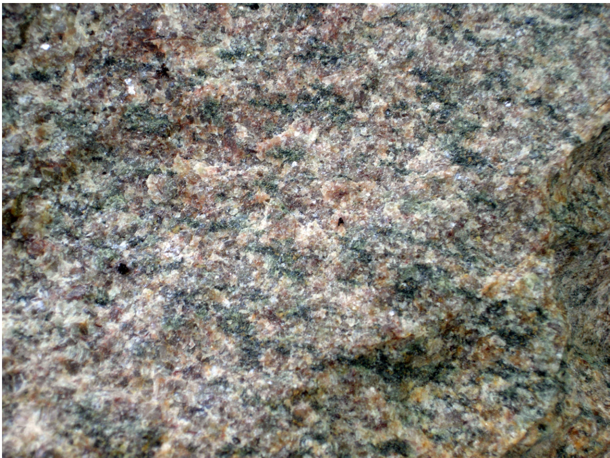
Fig. 4. Granitisk gnejs, gråröd, finkornig till fint medelkornig, gnejsig, ådrad, MGOo80o22A, 1393582/6168761, med de tekniska egenskaperna A_N -värde = 12 % och LA-värde = 31 %. Vyn är ca 4 x 5 cm. Foto: Mattias Göransson.
