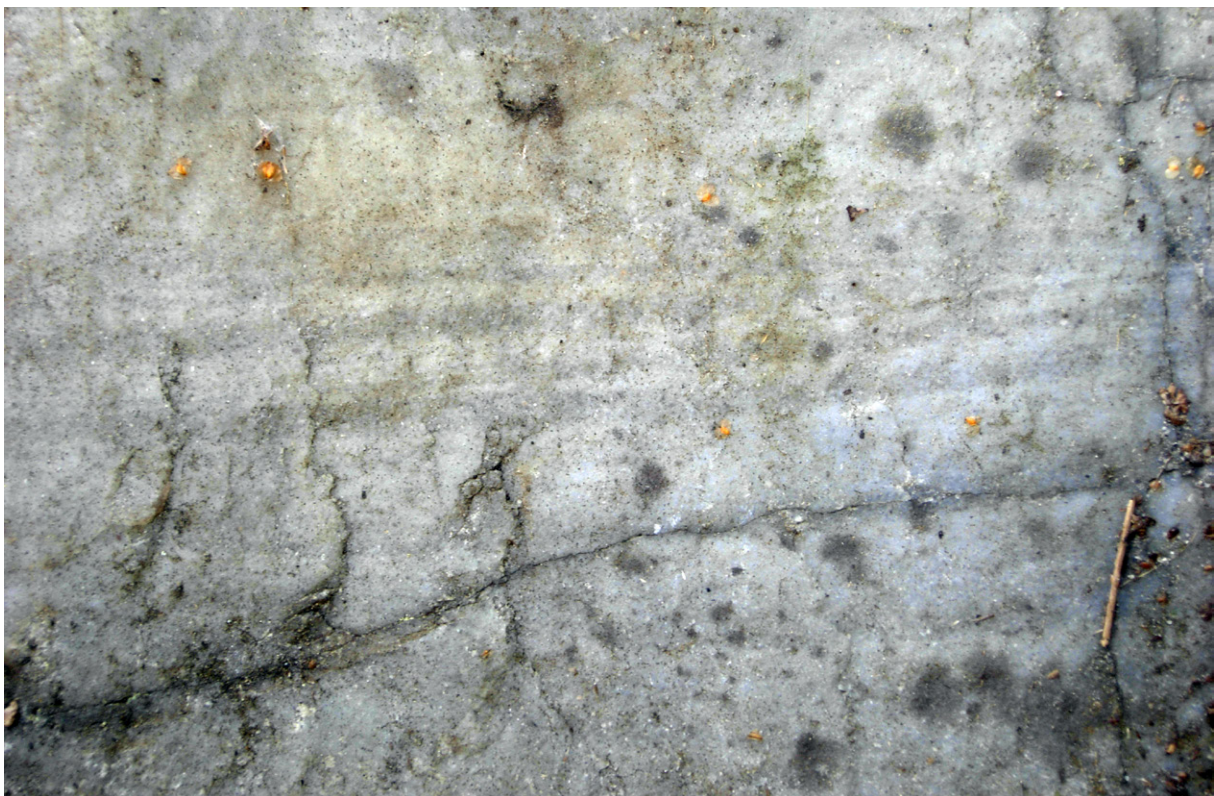
Fig. 5. Ljusfärgad grå, finkornig, kambrisk sandsten, MGO075107A, från det nedlagda stenbrottet Tobisborg, 1406650/6161630. Berget är sprött, motståndet mot fragmentering är lågt, A_N -värde = 7 % och LA-värde = 42 %. Vyn är ca 13 x 20 cm. Foto: Mattias Göransson.
