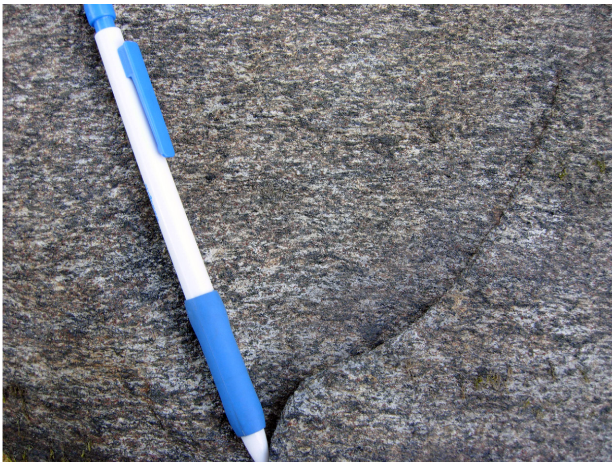
Fig. 6. Mörkt grå, folierad, granatförande amfibolit (MEKo70524A, 6224513/1388844) med dåliga tekniska egenskaper: A_N -värde = 28 % och LA-värde = 28 %. Foto: Mattias Göransson.
