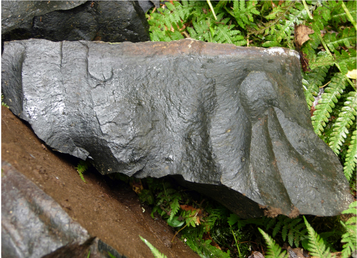
Fig. 7. Mörk, mycket finkornig basalt (MGO075111A, 6220356/1344415) med bra tekniska egenskaper: A_N -värde = 9 % och LA-värde = 12 %. Foto: Mattias Göransson.
