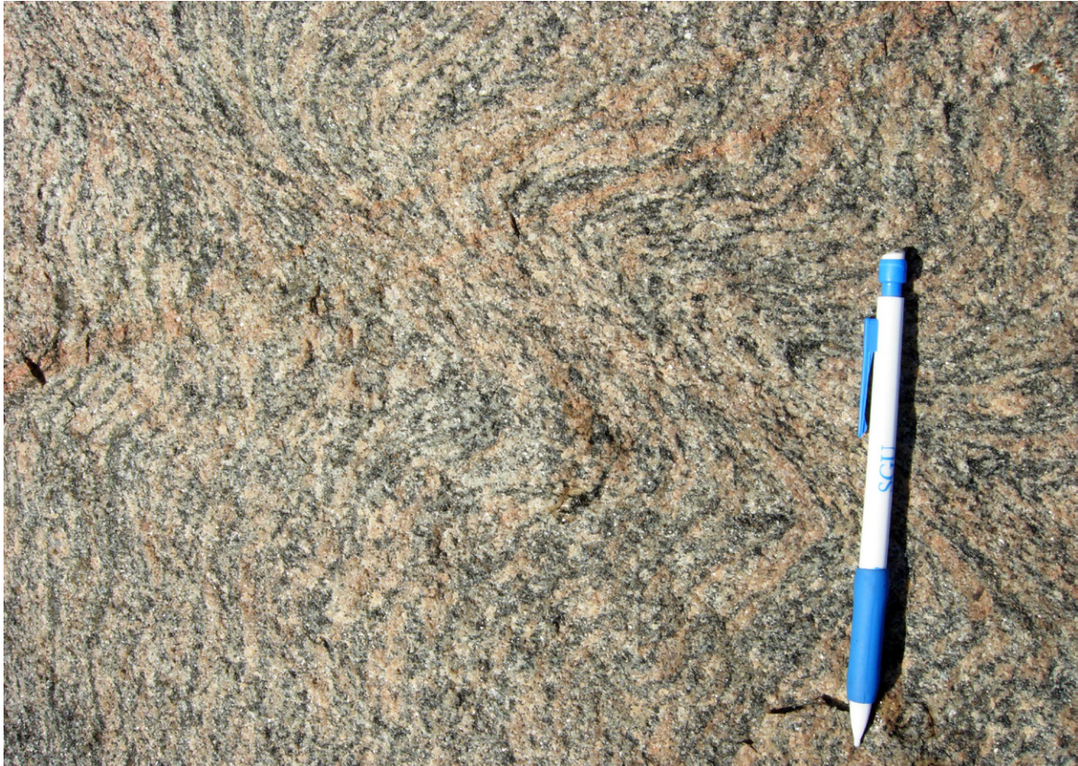
Fig. 5. Gråröd, medelkornig, veckad, granitisk gnejs (MEK070525A, 6235288/1334046) med bra tekniska egenskaper: A_N -värde = 9 % och LA-värde = 22 %. Foto: Mattias Göransson.
