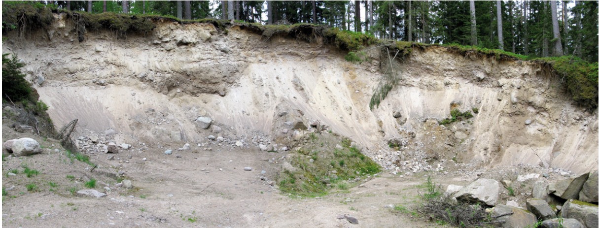
Fig. 12. En sju meter hög skärning i en moränsluttning 2,5 km väster om Fägerstad (9 a). I den sandiga moränen finns skikt av sand och grus ner till ca 4 m under markytan. Foto: Magnus Persson.
