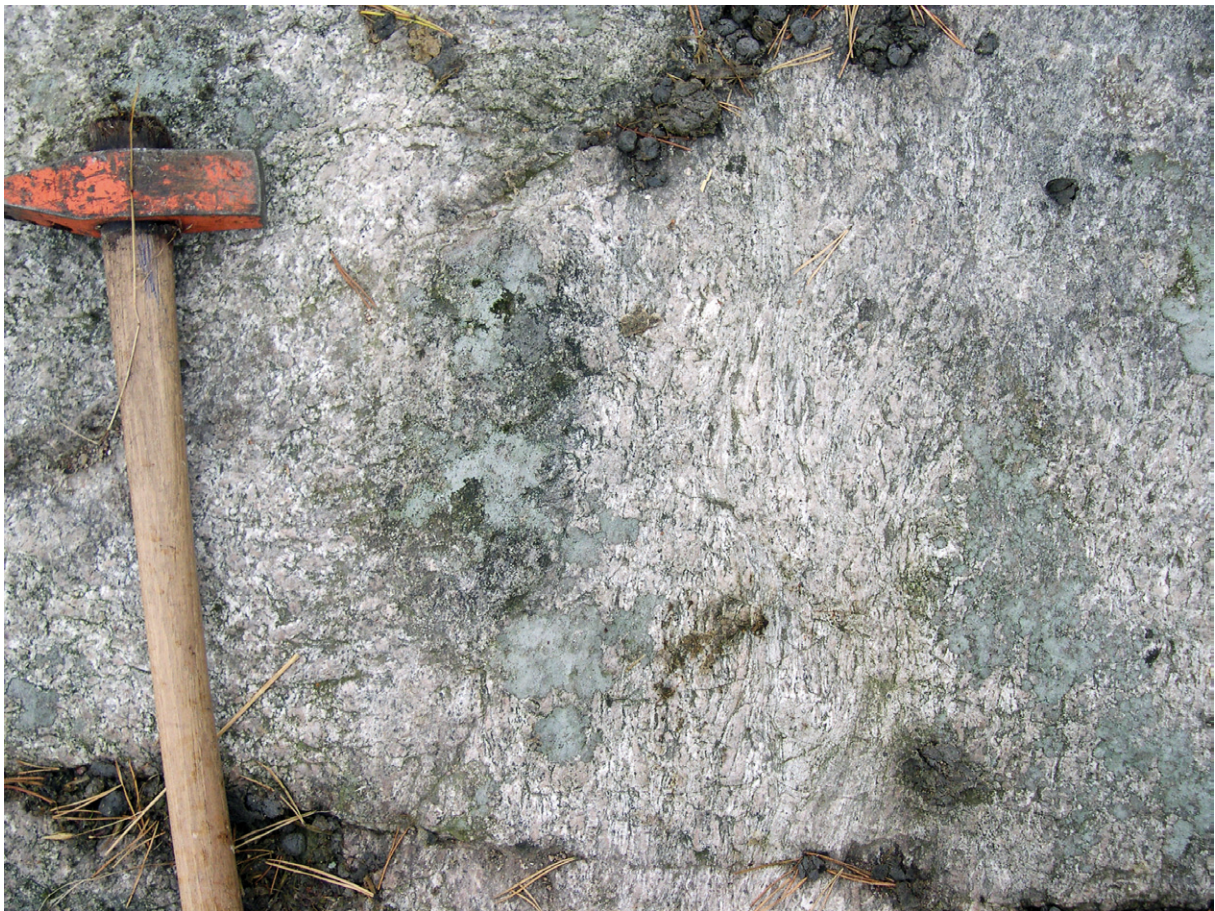
Fig. 10. Plastisk skjuvzon ( N40^{\circ}V/75^{\circ}S , 230/75 ) i en småporfyrisk monzogranit. Jämför den odeformerade delen till vänster i bilden med den deformerade delen med utdragna kalifältspatströkor till höger. Zonen uppskattas totalt vara 50–100 m bred, 6G Vimmerby NV (6389480/1501688). Foto: Dick Claeson.
