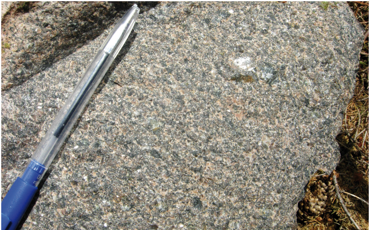
Fig. 9. Mörkt brunröd, finkornig till medelkornig, ojämnkornig monzogranit (Bkod = VII, MGOo80o33A, 6228o64/1389654) med mycket bra tekniska egenskaper, A_N -värde = 6 % och LA-värde = 19 %. Foto: Mattias Göransson.
