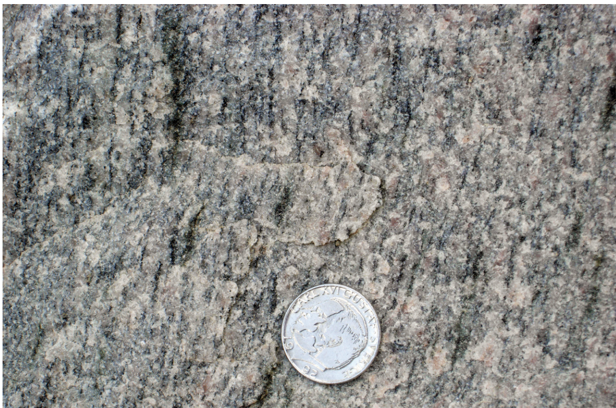
Fig. 6. Grå, gnejsig granit (Bkod = V, MGOo80oo6A) med medelbra tekniska egenskaper bryts i Skepparslövs bergtäkt, A_N -värde = 11 % och LA-värde = 30 %. Foto: Mattias Göransson.
