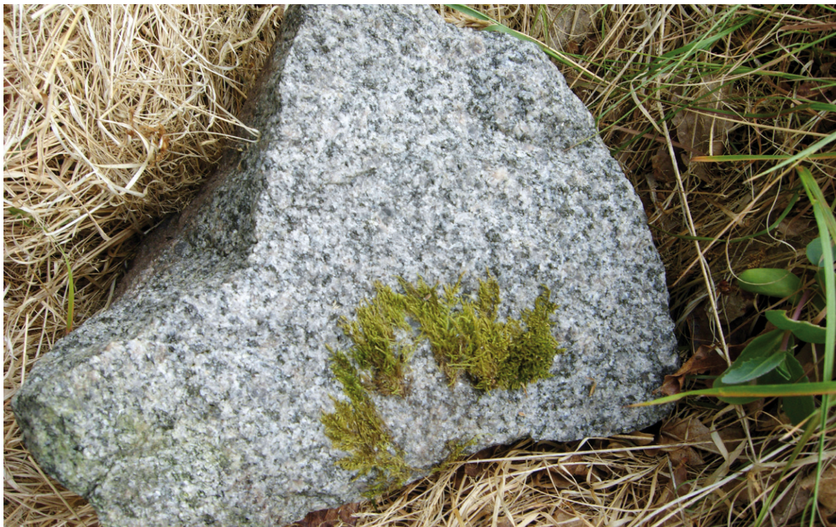
Fig. 8. Grå, rödgrå, medelkorrig granit (Bkod = VI, MGOo80o35A, 6220597/1396273) med medelbra tekniska egenskaper, A_N -värde = 11 % och LA-värde = 28 %. Foto: Mattias Göransson.
