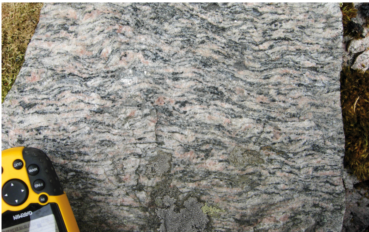
Fig. 7. Rödgrå till gråröd, gnejsig, kalifältspatporfyrisk granit (MGOo80o44A, 6224513/1388844) med dåliga tekniska egenskaper, A_N -värde = 15 % och LA-värde = 36 %. Foto: Mattias Göransson.
