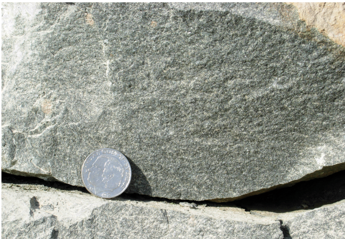
Fig. 10. Mörkt grönsvart, finkornig, permokarbonsk diabas (Bkod = X, MGOo80005A, 6213210/1389219) med bra tekniska egenskaper, A_N -värde = 10 % och LA-värde = 10 %. Foto: Mattias Göransson.
