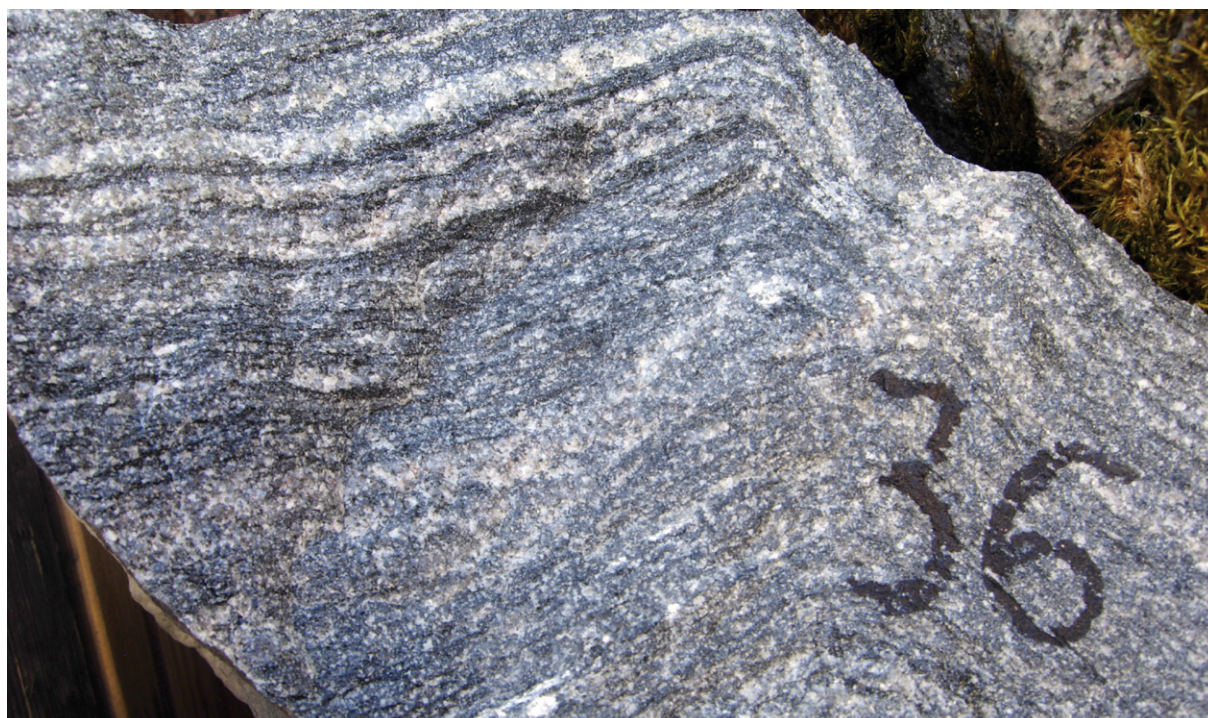
Fig. 5. Mörkt grå, bandad, glimmerrik paragnejs (Bkod = 1, MGO080036A) med medelbra tekniska egenskaper, A_N -värde = 12 % och LA-värde = 18 %. Foto: Mattias Göransson.
