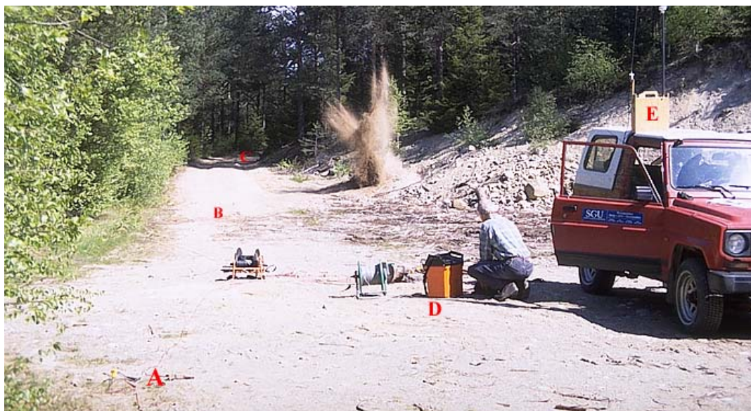
Fig. 4. Vid seismiska mätningar detoneras en mindre dynamitladdning och ljudvågorna som fortplantar sig i marken registreras av geofoner vid A, B och C. D är en seismograf som ritar upp och lagrar kurvor över ljudvågornas utbredning. E är en GPS-mottagare för positionering. Foto: C.-F. Müllern.
