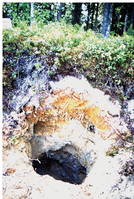
Fig. 1. Typisk grop för markgeokemisk provtagning av morän.
