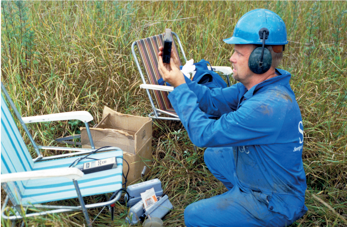
Fig. 6. Preliminära, kemiska analyser på salthalt, järnhalt och elektrisk ledningsförmåga görs i fält redan under pågående borrhning. Foto: C.-F. Müllern.
