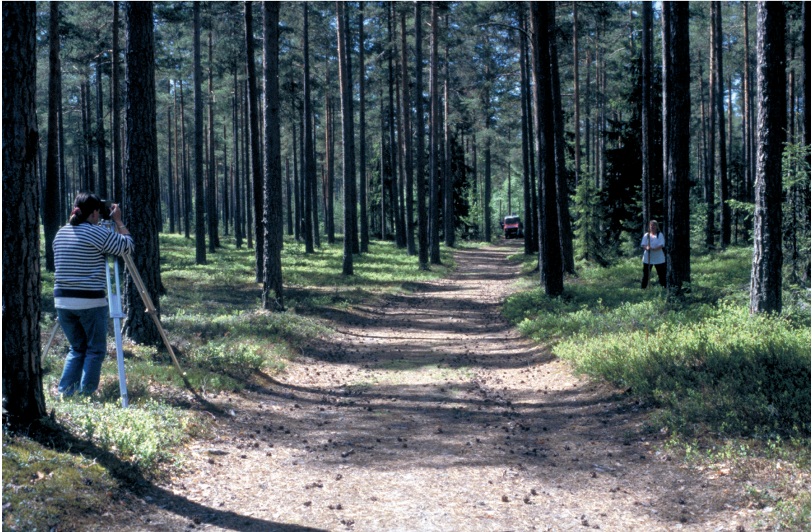
Fig. 4. Geofysiska profiler avvägs för att erhålla exakta mått på markytor, jordartsgränser, grundvattenytor och bergytor. Foto: C.-F. Müllern.
