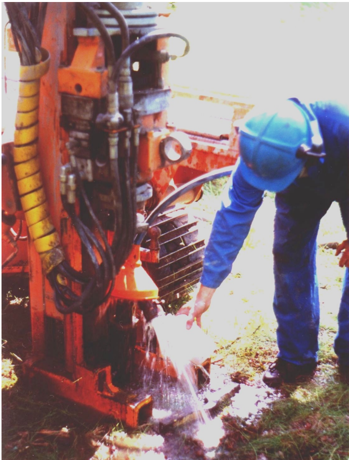
Fig. 53. Luftblåsning och vattenprovtagning av grundvattenrör 9904 på Tyskön. Foto: Thomas Aneblom.
