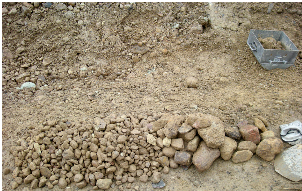
Figur 99. Den västra delen av Timmersdalavallen byggs upp av en jordart bestående av de två kornpopulationerna stenigt grus och lera. En fältsiktning genomfördes på den grova kornpopulationen. De stenar och gruskorn som siktades fram visas i högen på bilden. Foto: Tore Påsse.
