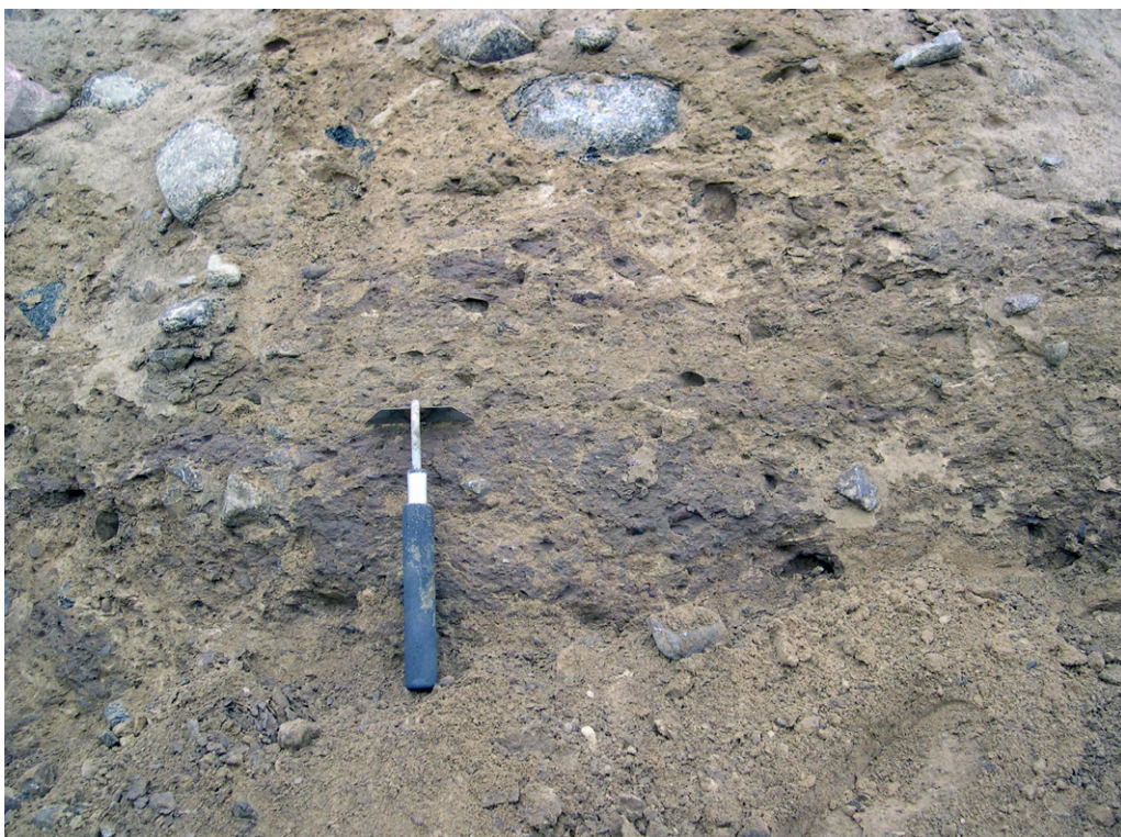
Figur 28. Enhet D i Cementa drumlinen. Moränen är en deformationsmorän och innehåller sliror från den underliggande sorterade enheten. Foto: Tore Påsse.
