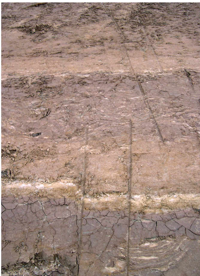
Figur 67. Det finns många möjligheter till feltolkningar vid i ler- varvskronologiska arbeten. Fotot visar en upprepansad del av varvig lera från centrala Skövde. Inom var- je varv finns skiktningar som skulle kunna misstolkas som varv, särskilt om undersökningen har gjorts från en borrhäla där det inte fanns möjlighet att följa enskilda skikt lateralt. Foto: Tore Påsse.
