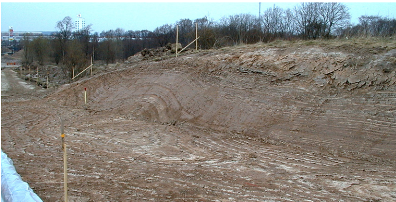
Fig. 51. Varvig rödbrun glacial lera som frilagts i samband med vägbygge vid Fyllinge (6 e, 6284152 1322803). Foto förf. 2002.
