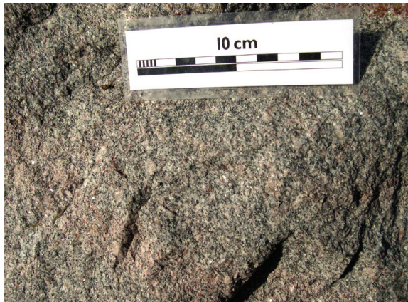
Fig. 8. Fint medelkornig, jämnkornig, grå-röd yngre granit. Bergarten har bra nötningsmotstånd (kulkvarnsvärde 9,9 %). Bergkvalitetsklass 1,5 (väg). FHA030269 (6605835/1636230).
