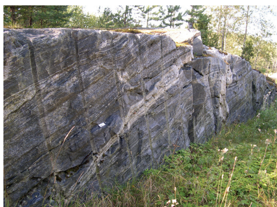
Fig. 5. Sedimentådergnejs. I bergarten finns glimmerhorisonter av växlande tjocklek. Heterogeniteten gör att hållfastheten blir lägre. Bergkvalitetsklass 3 (väg). FHA030253 (6607485/1629810).
