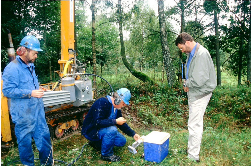
Fig. 10. Vid borrhningen norr om Björkliden uppmättes järnhalten i grundvattnet till mellan 2 och 5 mg/l och kloridhalten till 20 mg/l. Foto: C.-F. Müllern.
