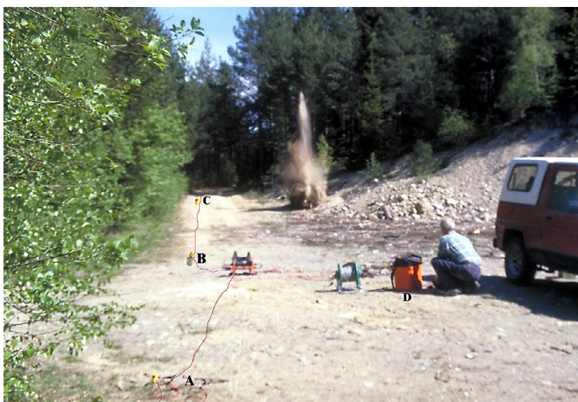
Fig. 7. Vid seismiska mätningar detoneras en mindre dynamitladdning och ljudvågorna som fortplantar sig i marken registreras av geofoner vid A, B och C. D är en seismograf som ritar upp och lagrar kurvor för ljudvågornas utbredning. Foto: C.-F. Müllern.
