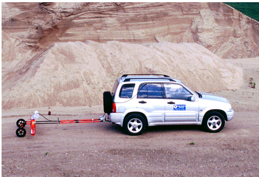
Fig. 6. Georadarmätningar ger information om lagerstrukturer och grundvattenytor. Antenn för sändning och mottagning är placerad framför de små hjulen. Utrustning för registrering och en bildskärm med samtidig visning av mätresultat finns inne i bilen. Foto: C.-F. Müllern.
