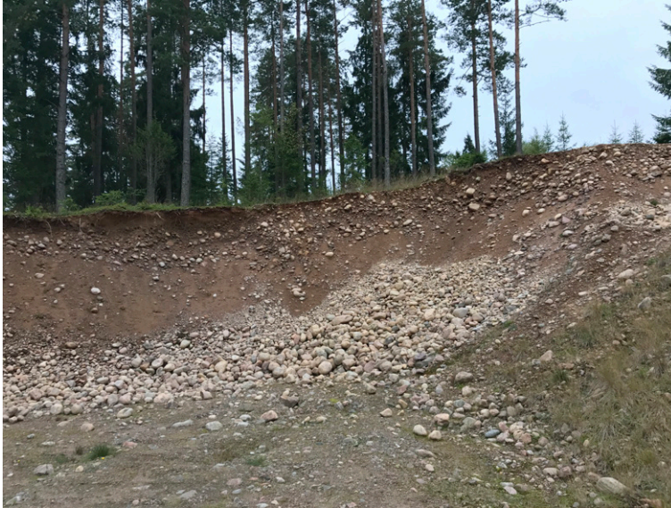
Figur 1. Skärning i isälvsavlagringen sydväst om Stomsjön. Sammansättningen är grovkornig. Djupet till berggrunden är här litet. Foto: Åsa Lindh, SGU.
