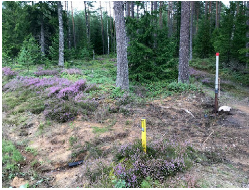
Figur 9. Observationsrör vid lokal BMW196301. Grundvattnets tryckyta når över markytan, dvs. artesiska förhållanden råder. Foto: Elisabeth Magnusson, SGU.
