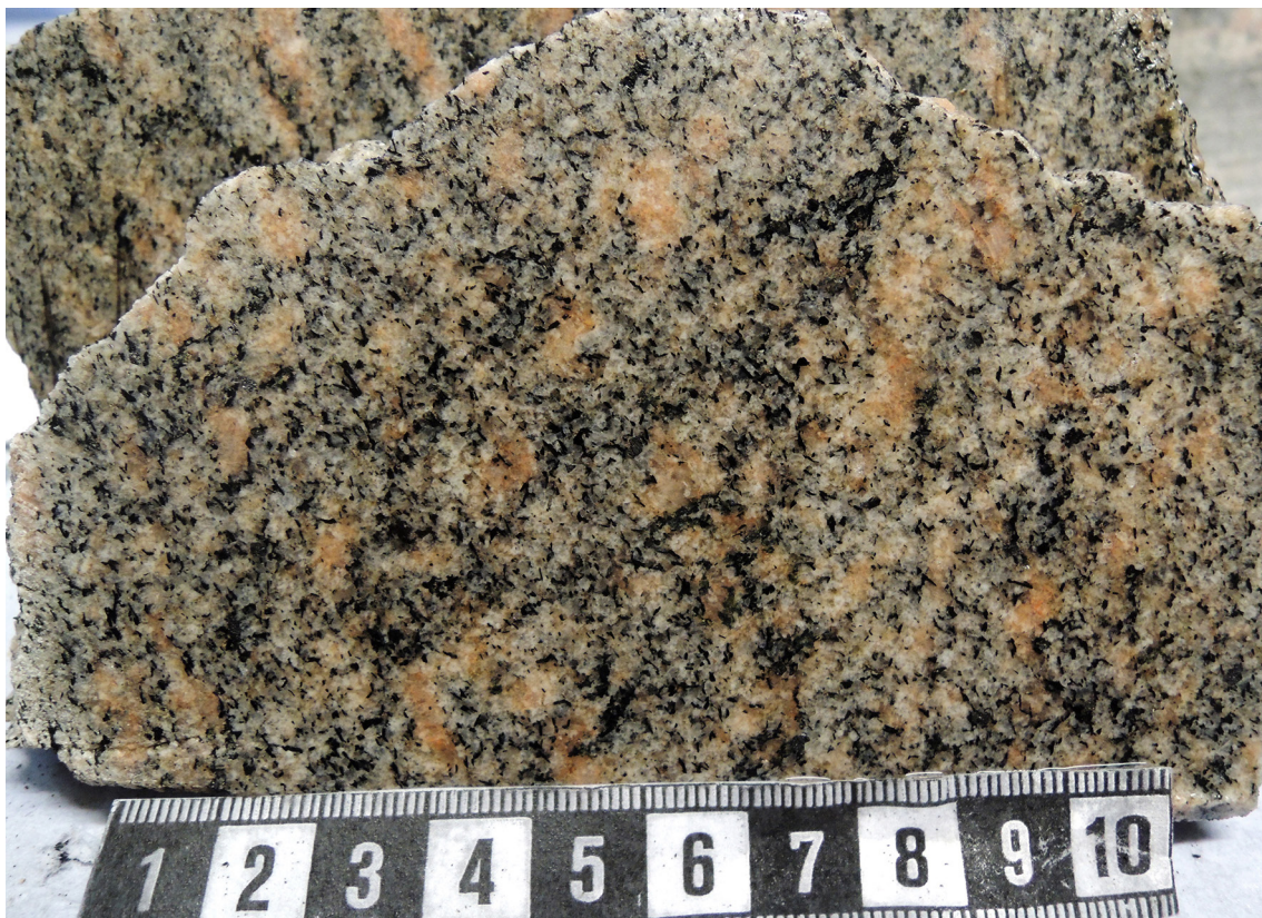
Figur 30. Sågad yta av kvartsmonzonitisk gnejs med ojämnkornig textur. Observation SPN210163, SWEREF 99 TM 6462121 N / 388177 E. Foto: Stefan Persson, SGU.
