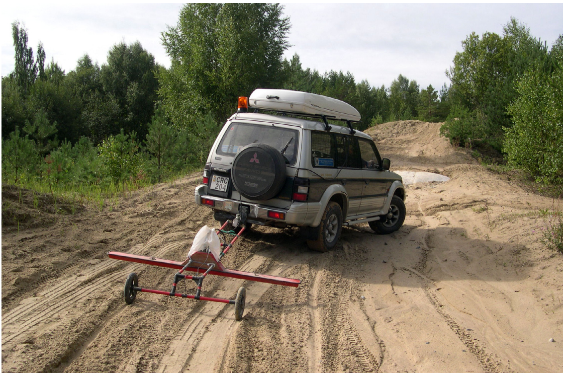
Fig. 3. Undersökning med georadar är en del av de geofysiska arbeten som utförs. Georadarapparaturen sitter monterad på en sulk. Georadarmätningar ger information om lagerstruktur och grundvattennivå. Foto: Sune Rurling.
