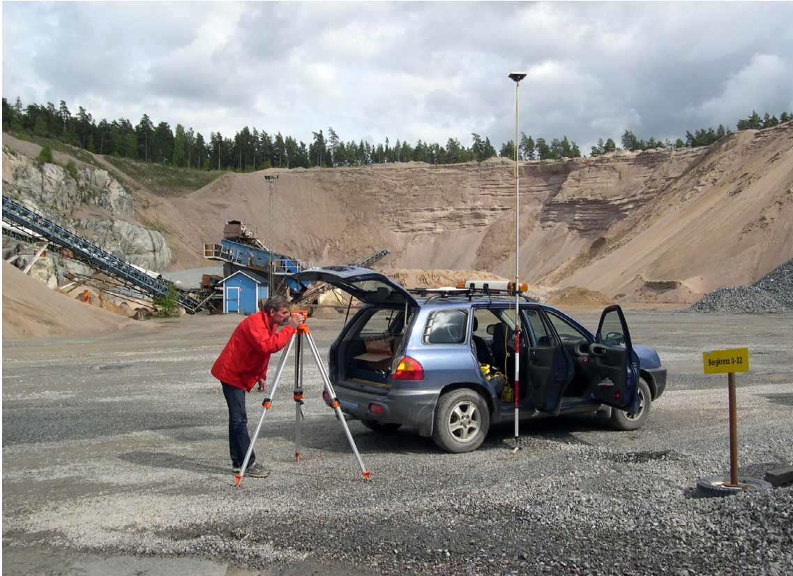
Fig. 5. För att kunna jämföra grundvattennivåer i olika grundvattenrör avvägs ett urval brunnar och grundvattenrör med hjälp av GPS. Hamra grustäkt, Botkyrka kommun. Foto: Torbjörn Persson.
