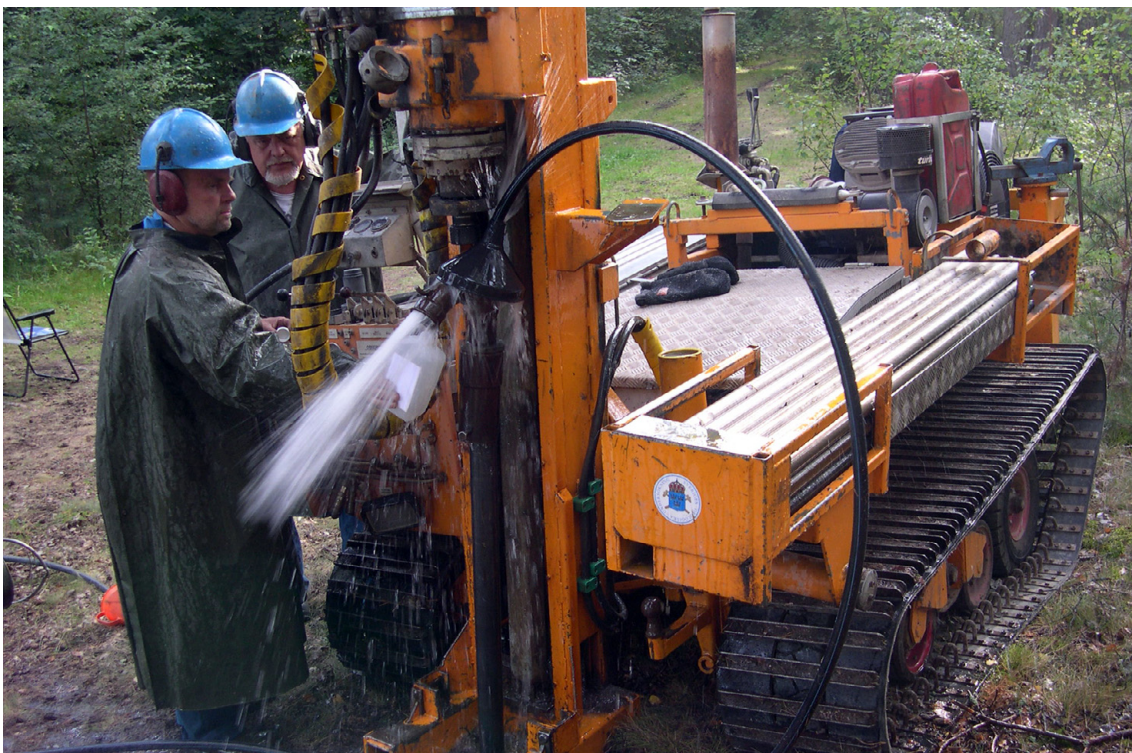
Fig. 4. Borrning i Lötenområdet. Efter utvärdering av de geofysiska undersökningarna utförs borrning på ett urval platser. I samband med sättning av grundvattenrör kan jord och vattenprov tas för analys från intressanta delar av lagerföljden. Foto: Torbjörn Persson.
