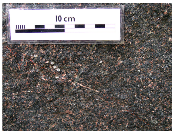
Fig. 4. Metahornbländit till gabbro, ojämnkornig, fint medelkornig. De röda kornen består av plagioklas färgade av järnutfällningar. Dåligt nötningsmotstånd. Bergkvalitetsklass 3 (väg) MEK010451A (6669240/1565980). Foto: Malin Sträng
