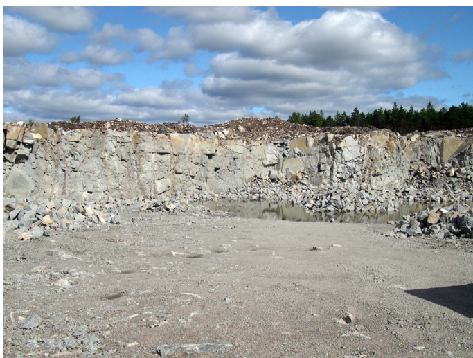
Fig. 2. Horrstatäkten (Stingtorpets Grus AB 2004). I täkten bryts en grå, folierad, medelkornig metagranit till granodiorit. Bergkvalitetsklass 1 (väg). MPA040040A (6645875/1556065). Foto: Malin Sträng
