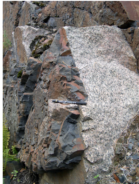
Fig. 8. Gång av svart, finkornig diabas i en rödgrå, medelkornig, folierad metagranit. Diabasen är provtagen (DLA030067B) och har det bästa nötningsmotståndet av de provtagna bergarterna i området (kulkvarnsvärde 5,8). Bergkvalitetsklass 1 (väg). Även graniten tillhör bergkvalitetsklass 1 (väg). (6646874/1555363). Foto: Malin Sträng
