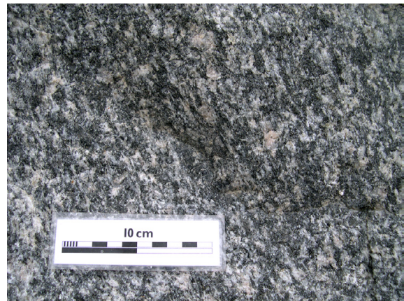
Fig. 6. Grå, folierad, medelkornig metatonalit från Buckarbytäkten. Bergkvalitetsklass 2 (väg). MAL010035A (6677637/1566203). Foto: Malin Sträng
