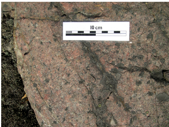
Fig. 7. Röd, medelkornig, ojämnkornig, kalifältspatporfyrisk, folierad metagranit. Mycket gott nötningsmotstånd (kulkvarnsvärde 6,7). Bergkvalitetsklass 1 (väg). MPA040039A (6642540/1573950). Foto: Malin Sträng
