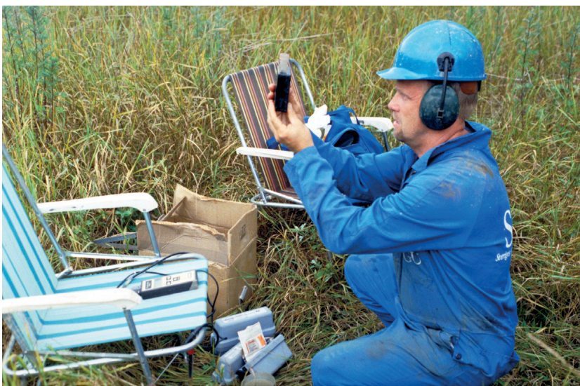
Fig. 6. Preliminära, kemiska analyser på salthalt, järnhalt och elektrisk ledningsförmåga görs i fält under pågående borrhning. Foto: C.-F. Müllern.
