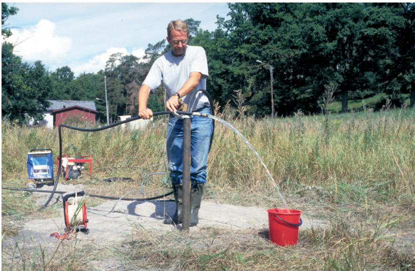
Fig. 8. Efter omsättning av drygt 1 000 liter vatten tas ett prov från observationsröret för fullständig kemisk analys. Foto: C.-F. Müllern.
