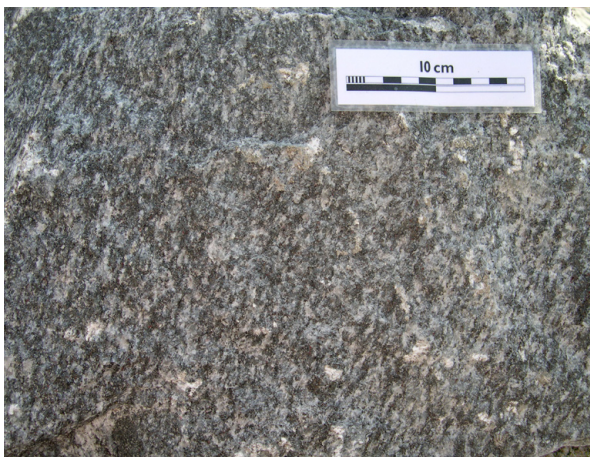
Fig. 8. Grå, folierad, medelkornig granodiorit från Trollstatäkten. Bergkvalitetsklass 2 (väg). CMT040008A (6550119/1618186). Foto Malin Sträng.
