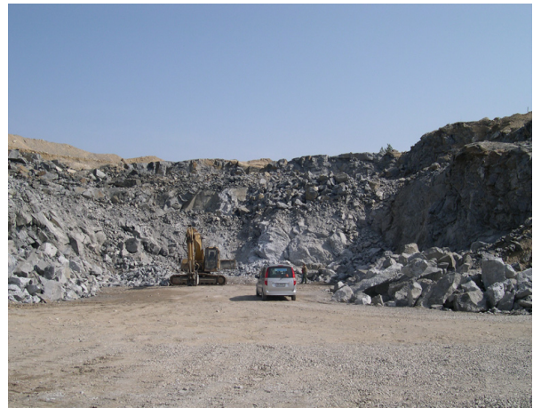
Fig. 7. Trollstatäkten (bryts av Nynäs-Ösmo LBC AB 2004). I täkten bryts en grå, folierad, medelkornig granodiorit. Bergkvalitetsklass 2 (väg). CMT040008A (6550119/ 1618186). Foto Malin Sträng.
