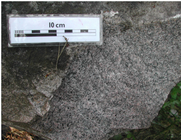
Fig. 5. Rödgrå, folierad, medelkornig granit från Ragnarök. Bergkvalitetsklass 1 (väg). CMT040013A (6546154/1611993). Foto Claes Mellqvist.
