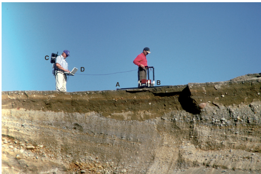
Fig. 3. Georadarmätningar ger information om lagerstrukturer och grundvattenytor. A och B är antenner för sändning och mottagning, C är styrenhet för datainsamling och D är dator med bildskärm. Jämför med t.ex. figur 45. Foto: C.-F. Müllern.
