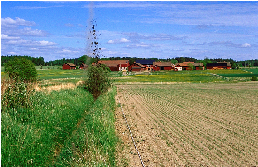
Fig. 16. Från de seismiska mätningarna över Örsundaåns dalgång vid Röcklinge. Vid varje skottpunkt används vanligen ungefär ett hekto dynamit. Jämför med den seismiska profilen figur 75, som uppmätts längs detta dike. Foto: C.-F. Müllern.
