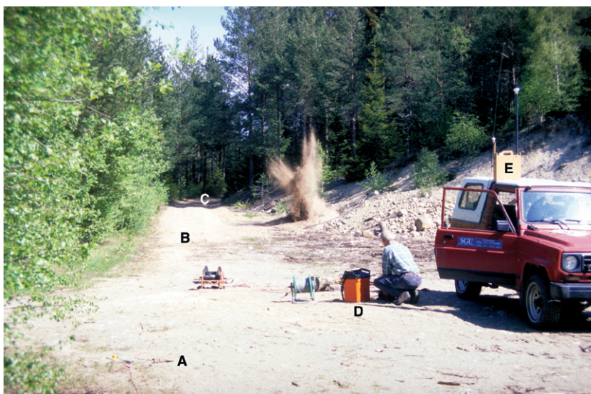
Fig. 4. Vid seismiska mätningar detoneras en mindre dynamitladdning och ljudvågorna som fortplantar sig i marken registreras av geofoner vid A, B och C. D är en seismograf som ritar upp och lagrar kurvor för ljudvågornas utbredning. E är en GPS-mottagare för positionering. Jämför med t.ex. figur 47. Foto: C.-F. Müllern.
