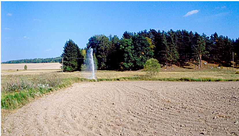
Fig. 22. Från de seismiska mät- ningarna vid Ål. Mätning med en skottpunkt i Örsundaån. Vid tallbacken är grundvat- tenmagasinet som mäktigast. Det sträcker sig från 5 m till 65 m under åns nivå. Magasi- nets botten når ca 25 m under havsnivån. Se även den seis- miska profilen i figur 76 som är uppmätt ungefär i siktlinjen på detta ställe. Foto: C.-F. Müllern.
